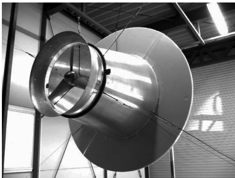
Figura 10 - Difusor flangeado ( flanged diffuser ).
