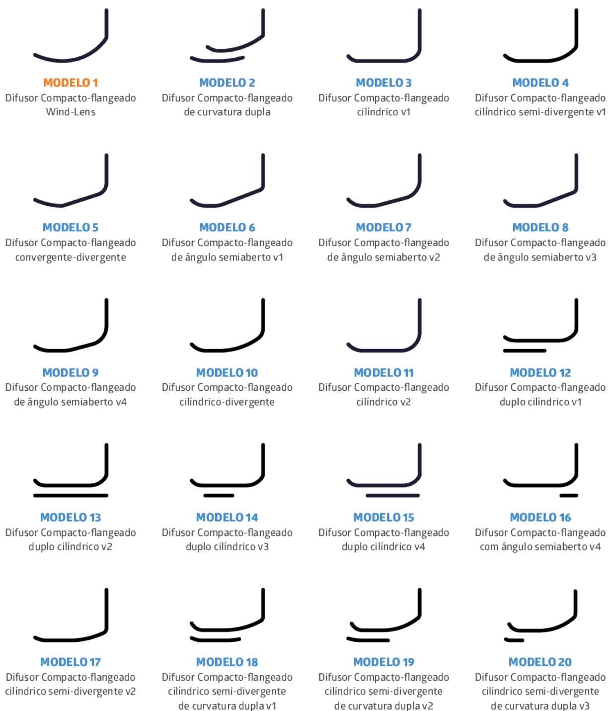
Figura 29 - Geometrias de difusores desenvolvidas para esta pesquisa.
