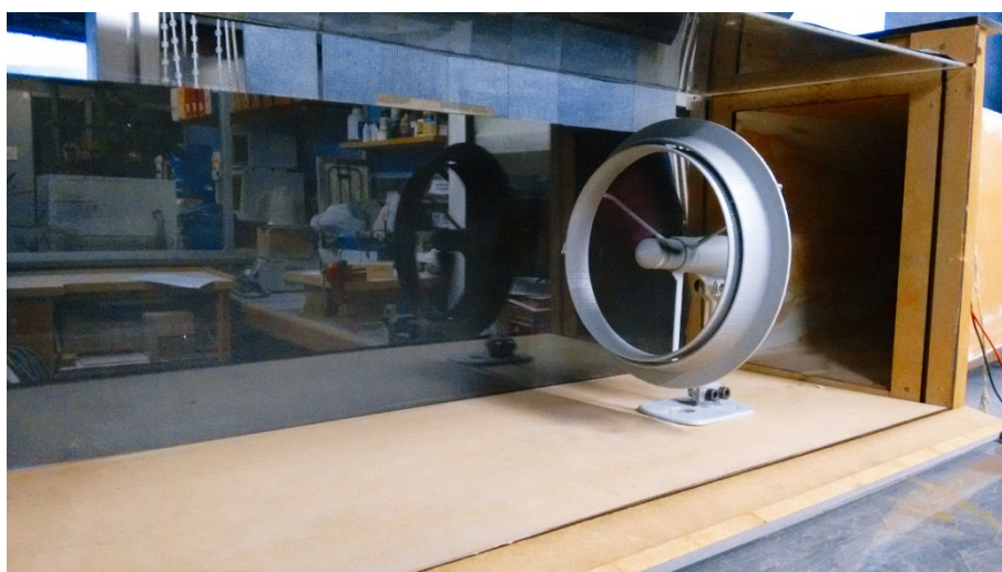
Figura 65 - TEPE-01 posicionada na seção de testes do túnel de vento.
