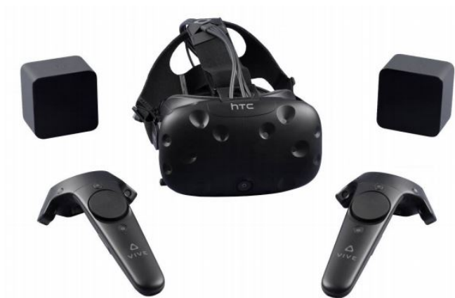
Figura 39 - Capacete HTC Vive, seus sensores cúbicos que mapeiam a posição do jogador no ambiente e seus dois controladores com trackpads circulares. Disponível em: < https://www.electronicproducts.com/uploadedImages/Multimedia/Video/HTC-Vive.JPG >. Acesso em 10 de novembro de 2017.
