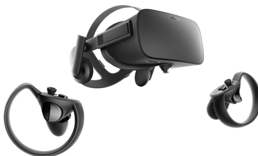
Figura 38 - Dispositivo de realidade virtual Oculus Rift e seus dois controladores. Disponível em: < https://www.oculus.com >. Acesso em 10 de março de 2017.
