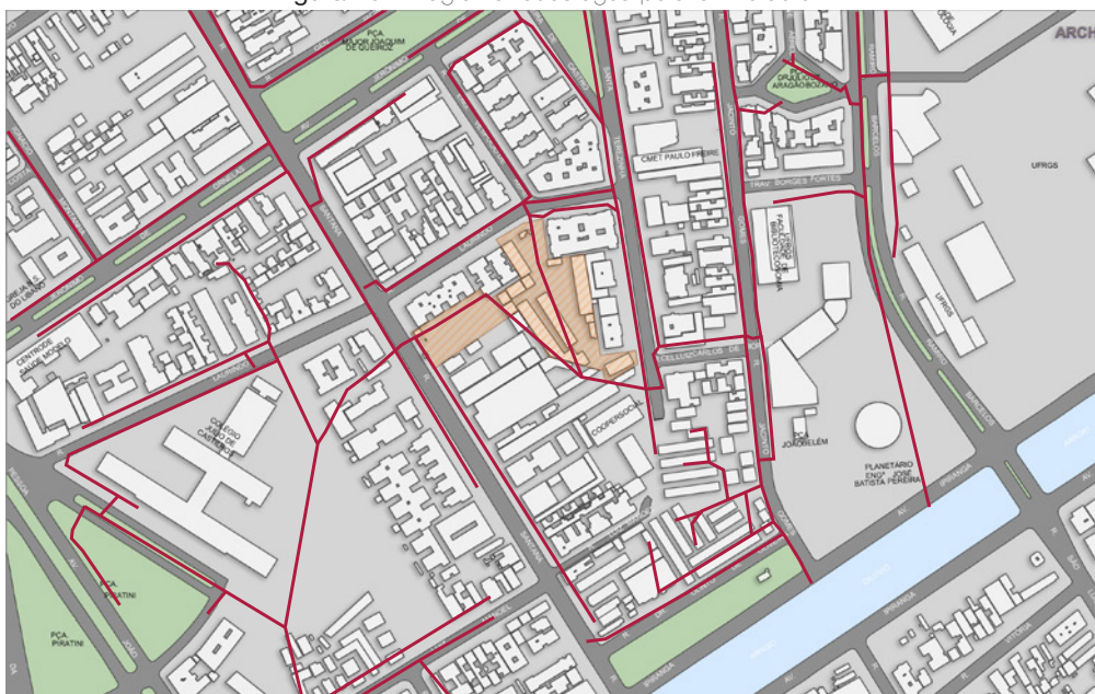
Figura 27 - Diagrama redes esgoto pluvial. Do autor.
