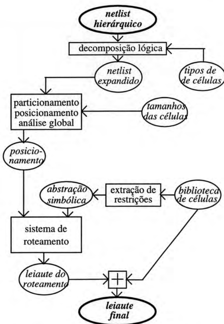
FIGURA 4.1 - Estrutura do Sistema TRAMO2
