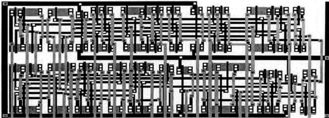
FIGURA 3.5 - Leiaute de um circuito gerado pelo TROPIC.
