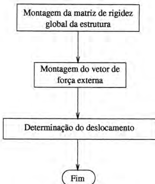
Figura 7.2: Cálculo da resposta da estrutura (flexibilidade)
