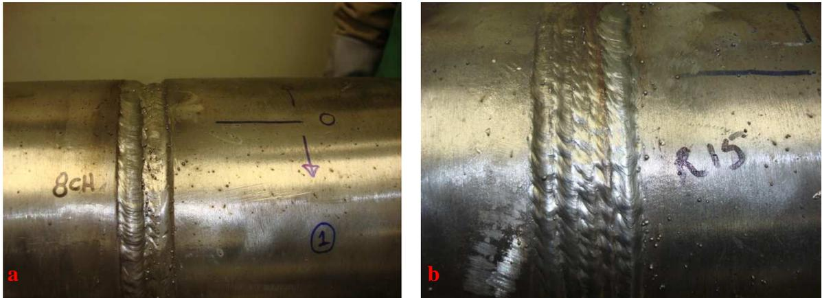
Figura 31 – Aspecto dos cordões de enchimento (a) e acabamento (b) do CP1 (Ar-He-CO<sub>2</sub>)
