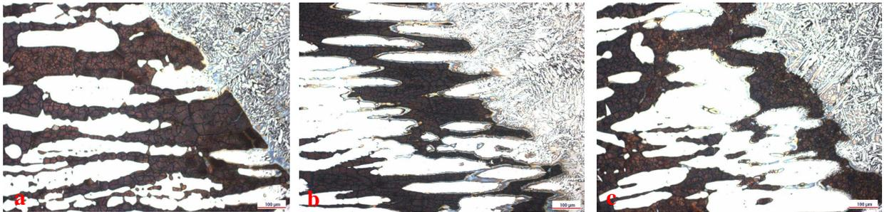
Figura 41 – Microestrutura da ZAC. (a) CP1, (b) CP2 e (c) CP3. Aumento de 400x.
