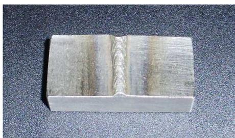
Figura 42 – Formato do corpo de prova de imersão em FeCl<sub>3</sub>. Tamanho 50x25x14 mm.
