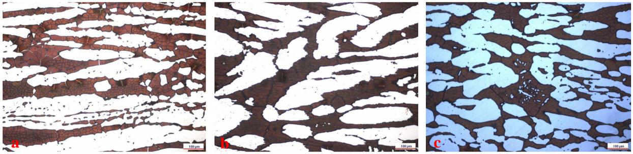
Figura 35 – Microestrutura do Metal Base. (a) CP1, (b) CP2 e (c) CP3. Aumento de 400x.
