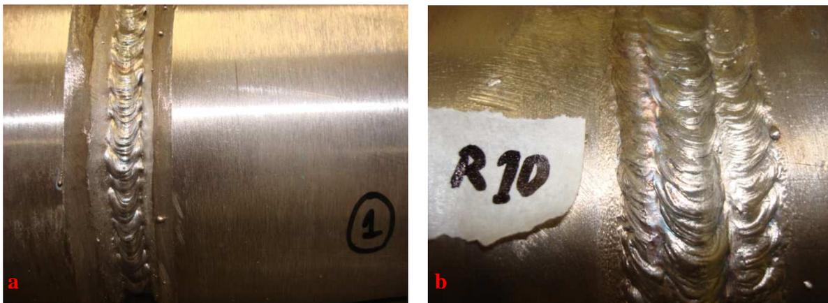
Figura 33 – Aspecto dos cordões de enchimento (a) e de acabamento (b) do CP3 (Ar puro).
