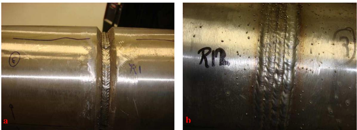
Figura 32 – Aspecto dos passes de enchimento (a) e acabamento (b) do CP2 (Ar-N<sub>2</sub>-CO<sub>2</sub>).
