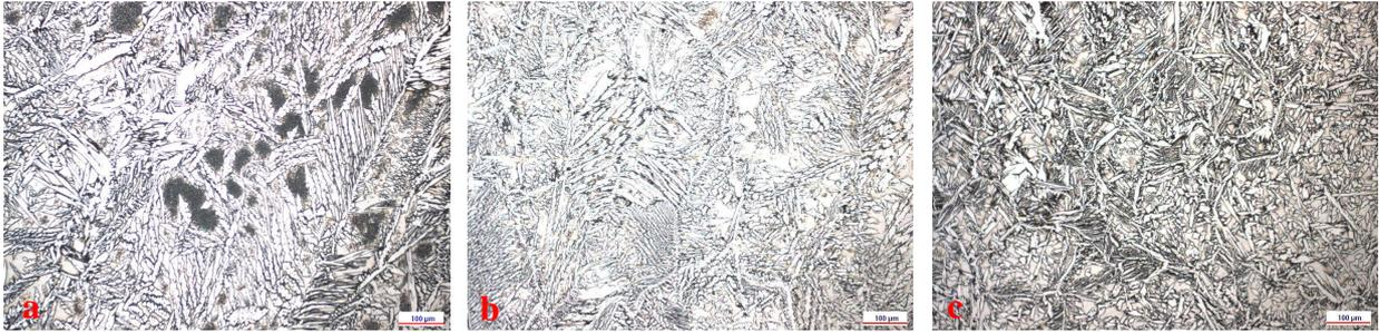
Figura 37 - Microestrutura do Metal de Solda. (a) CP1, (b) CP2 e (c) CP3. Aumento de 400x.
