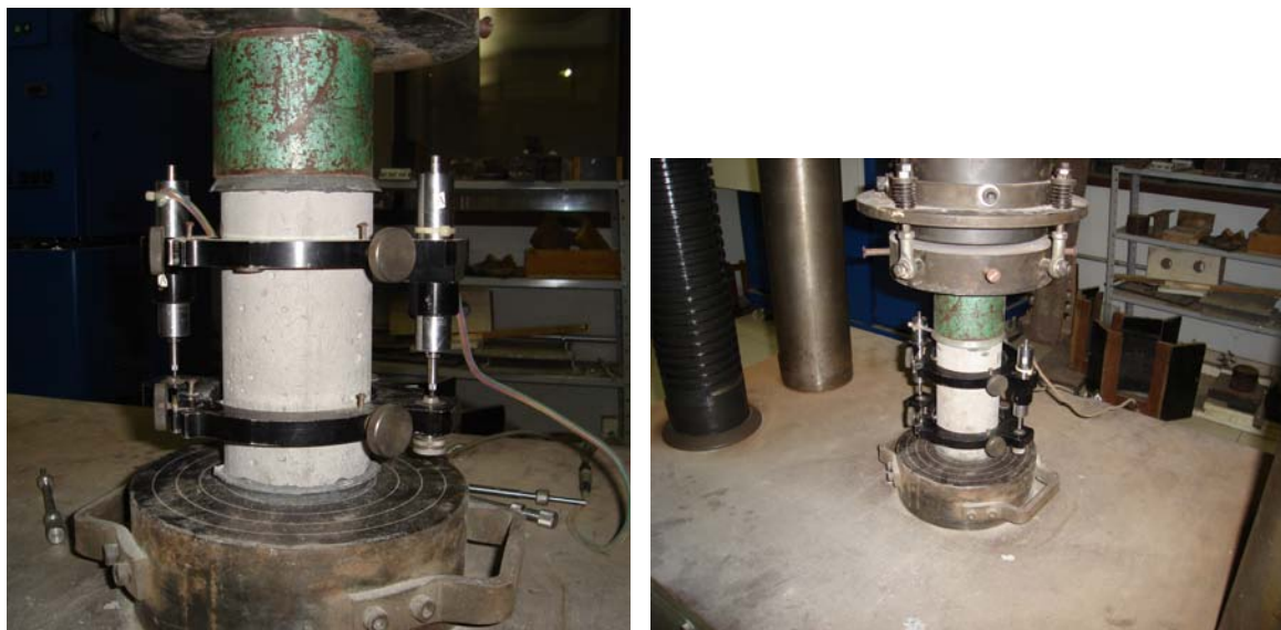
Figura 26: execução do ensaio de módulo de elasticidade com a utilização dos LVDTs
