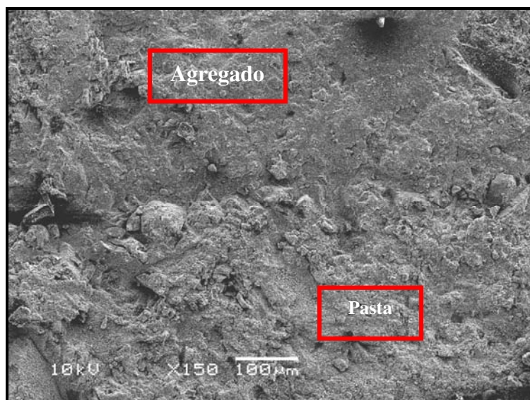
Figura 63: vista geral da interface agregado-pasta ampliada em 150 vezes.
