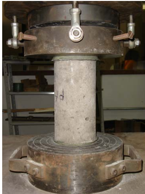
Figura 28: aplicação do pré-carregamento nos concretos
