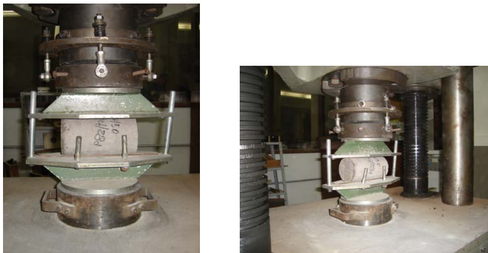
Figura 25: execução do ensaio de tração por compressão diametral
