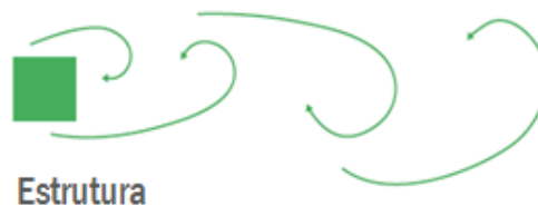
Figura 2. 3 – Turbulência gerada pela própria estrutura Fonte: Adaptado de Irwin et al. (2013)
