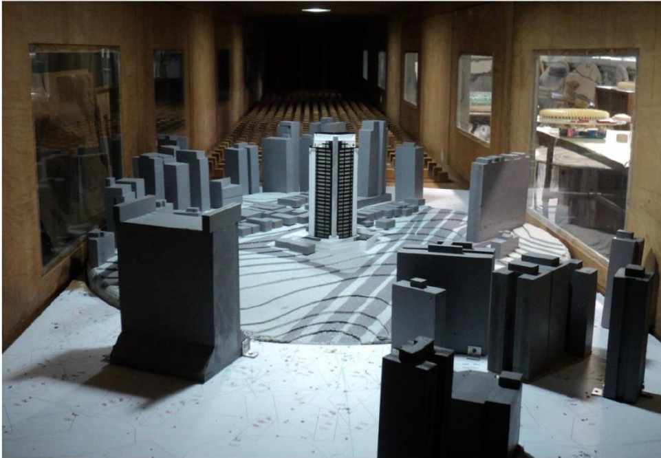
Figura 3.3 – Ensaio em túnel de vento considerando as condições de vizinhança – vista da fachada frontal do Prédio A. Fonte: Loredo-Souza e Rocha (2011a).
