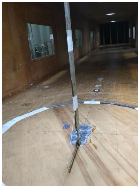
Figura 3. 16 – Anemômetro de fio quente para medição da velocidade do vento Fonte: O autor (2018)
