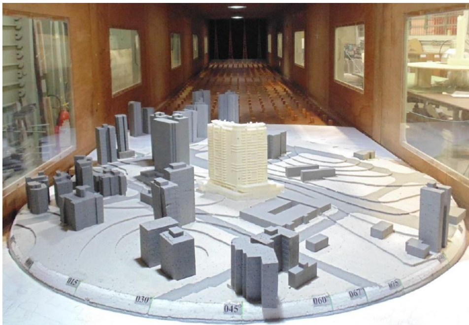
Figura 3.4 – Ensaio em túnel de vento considerando as condições de vizinhança – vista da fachada frontal do Prédio B. Fonte: Loredo-Souza e Rocha (2017)
