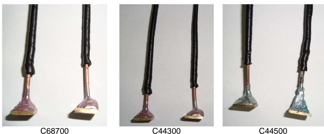
Figura 3.3- Amostras com eletrodos soldados e encapados com fita isolante auto-retrátil.
