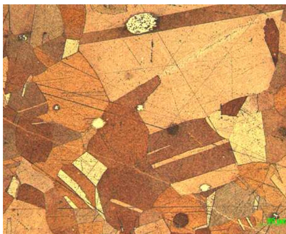
Seção longitudinal com aumento de 200x
