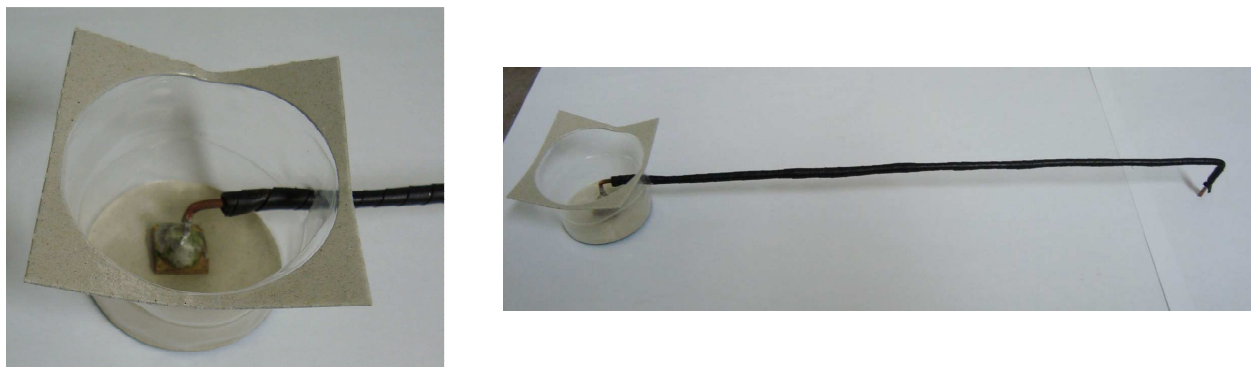
Figura 3.4 – Amostra colocada em recipiente de plástico para vertimento da resina de embutimento a frio.
