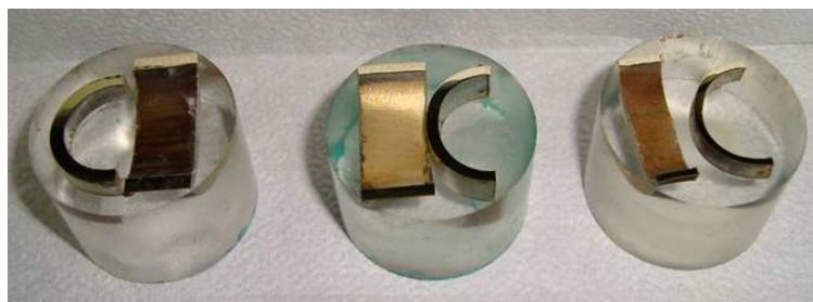
Figura 3.2 – Amostras para ensaio metalográfico após preparação de superfície. Da esquerda para direita: C68700, C44300, C44500.
