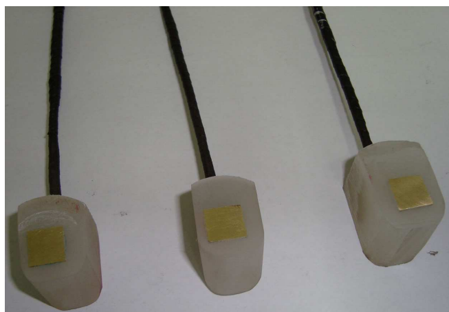
Figura 3.5 - Corpos de prova para levantamento de curvas de polarização, da esquerda para direita: C44300, C44500, C68700.
