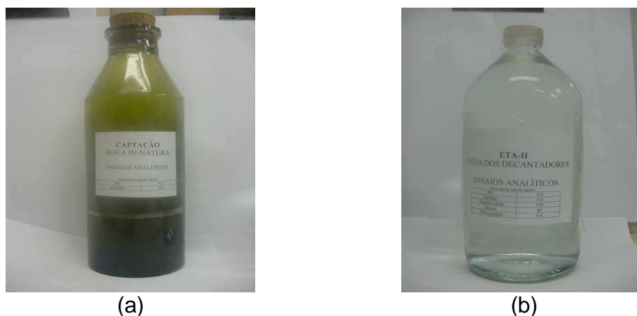
Figura 2.6 – a) aspecto da água in natura do rio Tamandateí e b) água após o processo de clarificação 10
