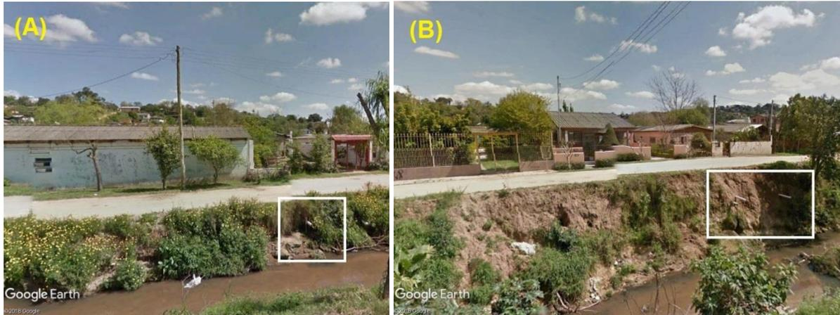
**Figura 29:** Nas imagens A (Google Earth - Street View, set/2011, Coordenadas: Lat. 30° 3'35.95"S; Long. 51° 4'55.46"O) e B (Google Earth - Street View, set/2011, Coordenadas: Lat. 30° 3'30.24"S; Long. 51° 4'52.34"O) observam-se os canos e tubos de PVC que despejam os esgotos domésticos diretamente no leito do arroio Dornelinhos (afluente do arroio Feijó). Modificado por: I.S. Ronconi - abril/2018.
