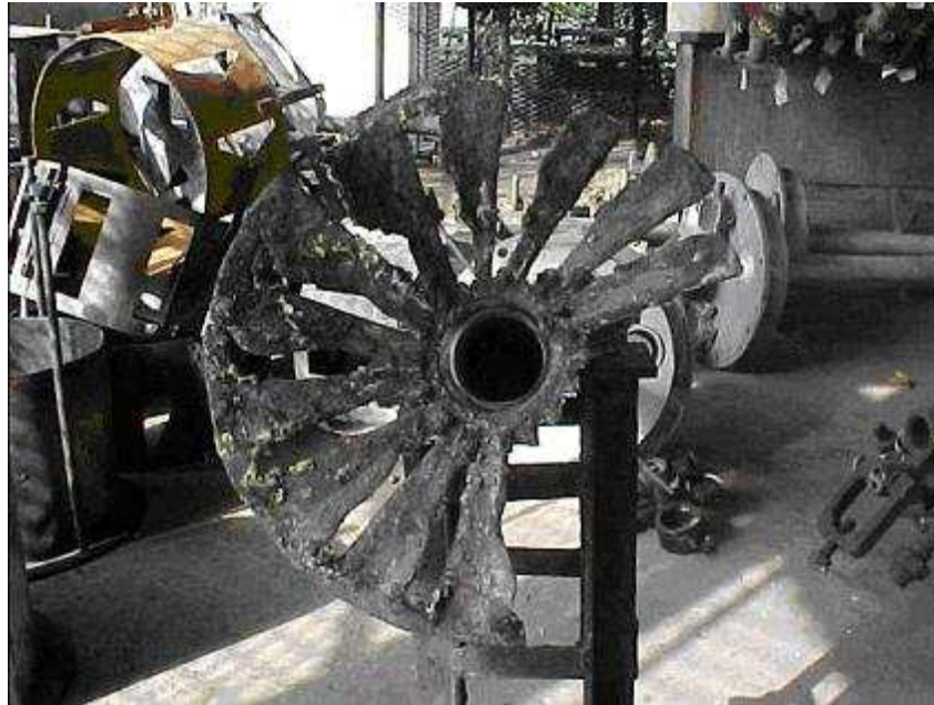
Figura 6.16- Difusor de ar corroído com acentuada perda de material (REDUC, 2003).
