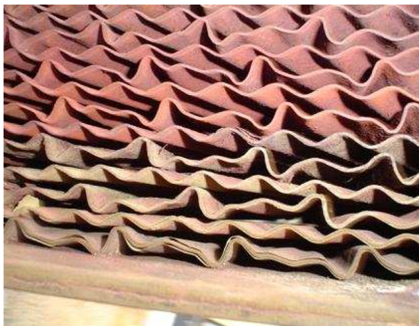
Figura 6.13- Detalhe do cesto localizado na face de saída de ar quente da colméia com as chapas de aço corrugadas revestidas com \text{Nb}_2\text{O}_5 , inspeção em dezembro de 2005 (REDUC, 2005).
