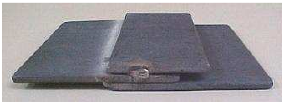
Figura 6.21- Corpo-de-prova revestido com Nb 2 O 5 (SCHULTZ, 2003).
