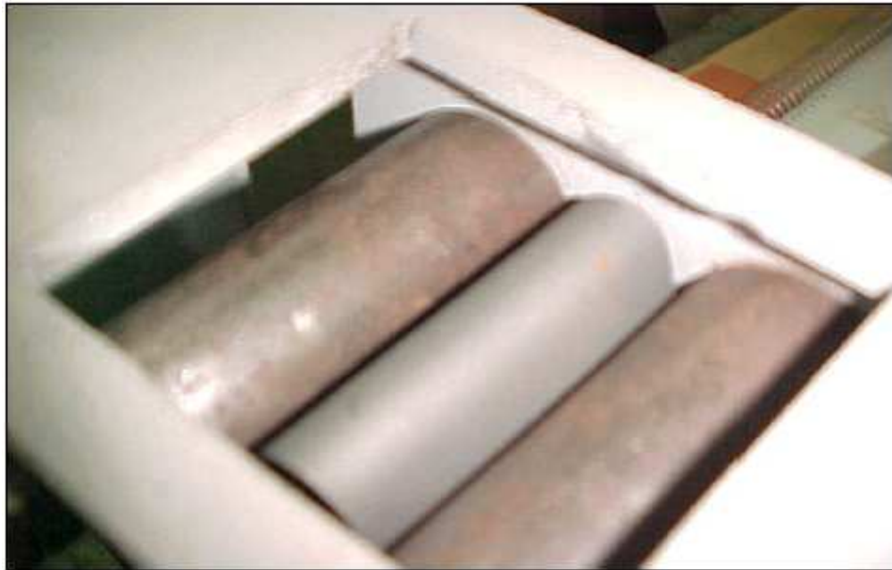
Figura 4.33- Corpos de prova revestidos com Nb após dobramento (MARIANO et al. , 2007).
