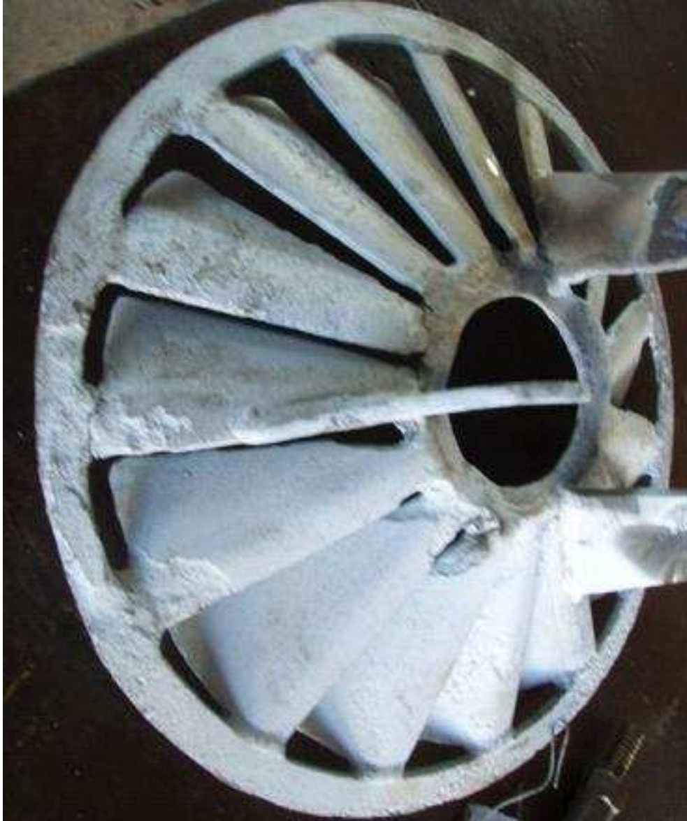
Figura 6.18 - Difusor de ar revestido com Nb_2O_5 , inspeção em outubro de 2005 (REDUC, 2005).
