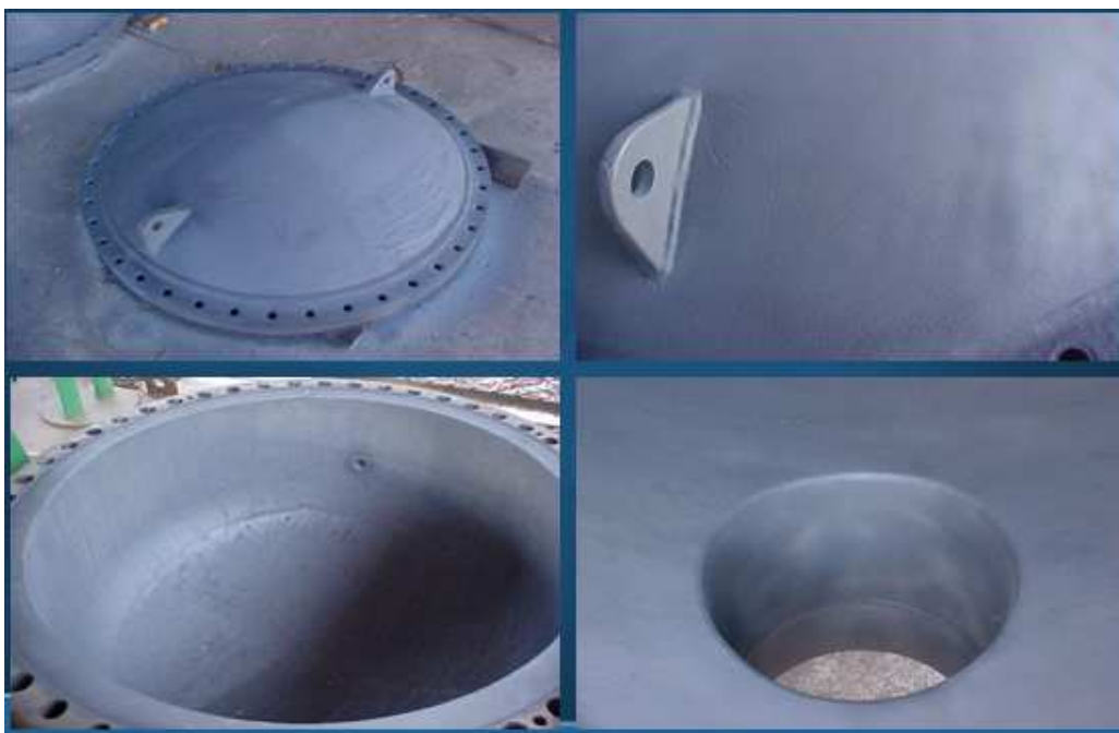
Figura 5.5- Tampo flutuante, boleado e bocal após deposição do filme de Nb_2O_5 (SCHULTZ, 2003).
