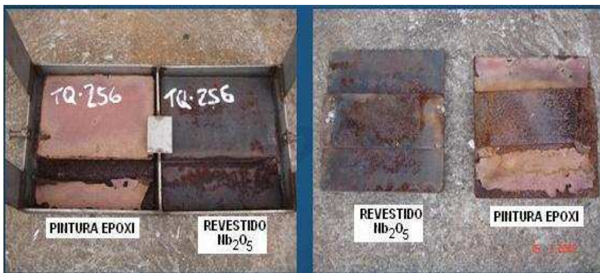
Figura 6.23- Corpos-de-prova revestidos com pentóxido de nióbio e com tinta epóxi, inspeção em março de 2009 (Autoria das Fotos de Marcelo Schultz).
