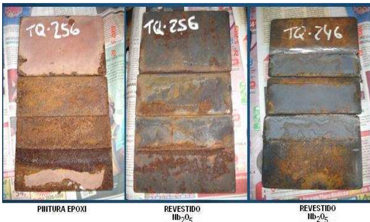
Figura 6.25- Chapas revestidas com Nb_2O_5 (centro e à direita) e com tinta epóxi (à esquerda) dos corpos-de-prova ensaiados nos tanques de armazenamento de querosene e óleo combustível após corte por esmerilhamento, inspeção em março de 2009 (Autoria das Fotos de Marcelo Schultz).
