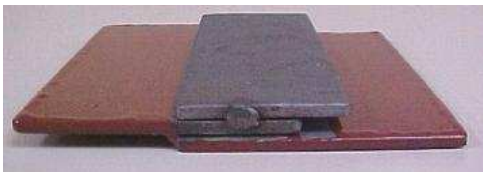
Figura 6.22- Corpo-de-prova com as duas chapas inferiores revestidas com tinta epóxi e a superior sem revestimento (SCHULTZ, 2003).
