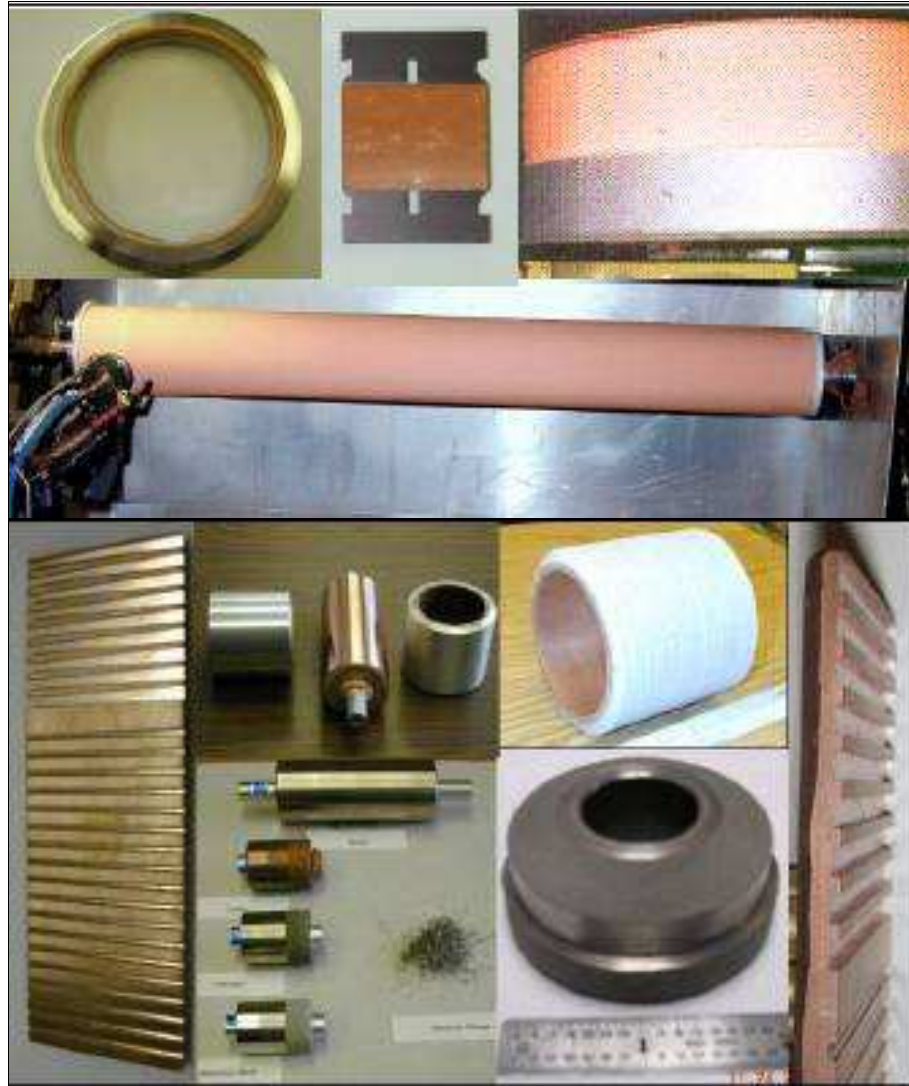
Figura 4.28- Peças típicas revestidas por aspersão térmica (KARTHIKEAN, 2004).
