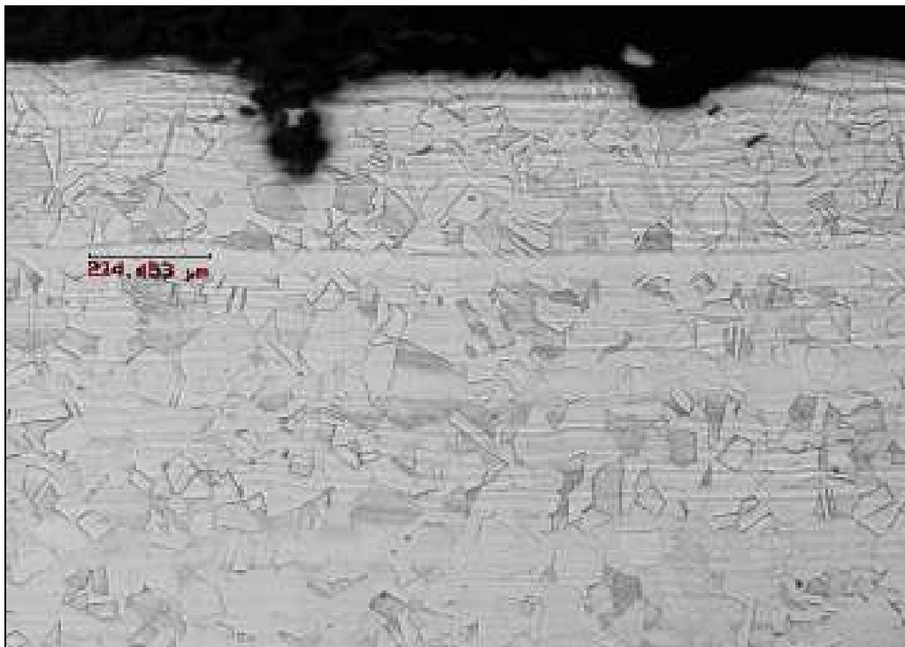
Figura 4.12- Micrografia da parede do tubo com pites (AL-SUBAI et al. , 2009).
