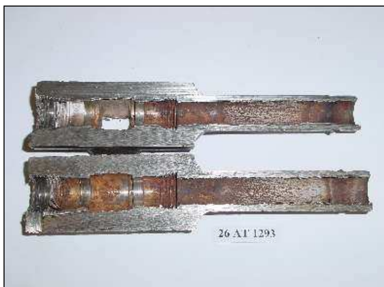
Figura 4.10- Tubos em corte de aço 316L atacados por cloretos, mostrando zona corroída por pitting (AL-SUBAI et al. , 2009).
