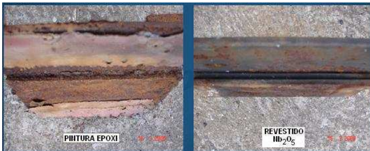
Figura 6.24- Corpos-de-prova com pintura epóxi com corrosão em frestas e niobizado sem sinais, inspeção em março de 2009 (Autoria das Fotos de Marcelo Schultz).
