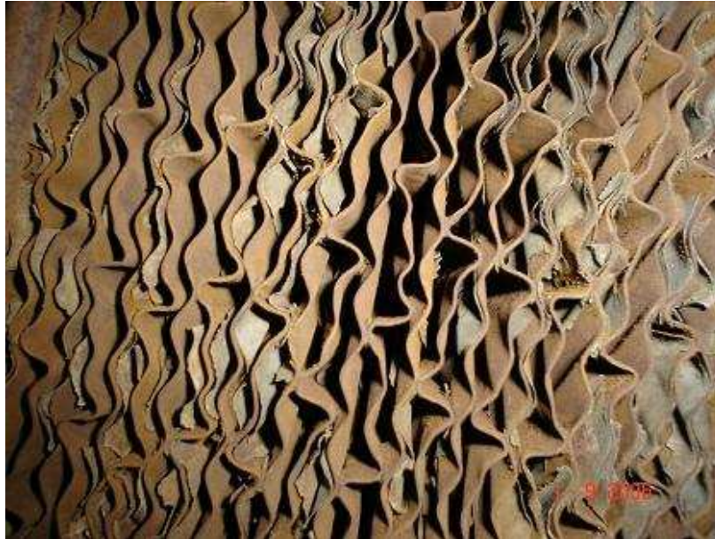
Figura 6.12- Aspecto desfolhado do \text{Nb}_2\text{O}_5 das chapas corrugadas, inspeção em setembro de 2006 (REDUC, 2006).
