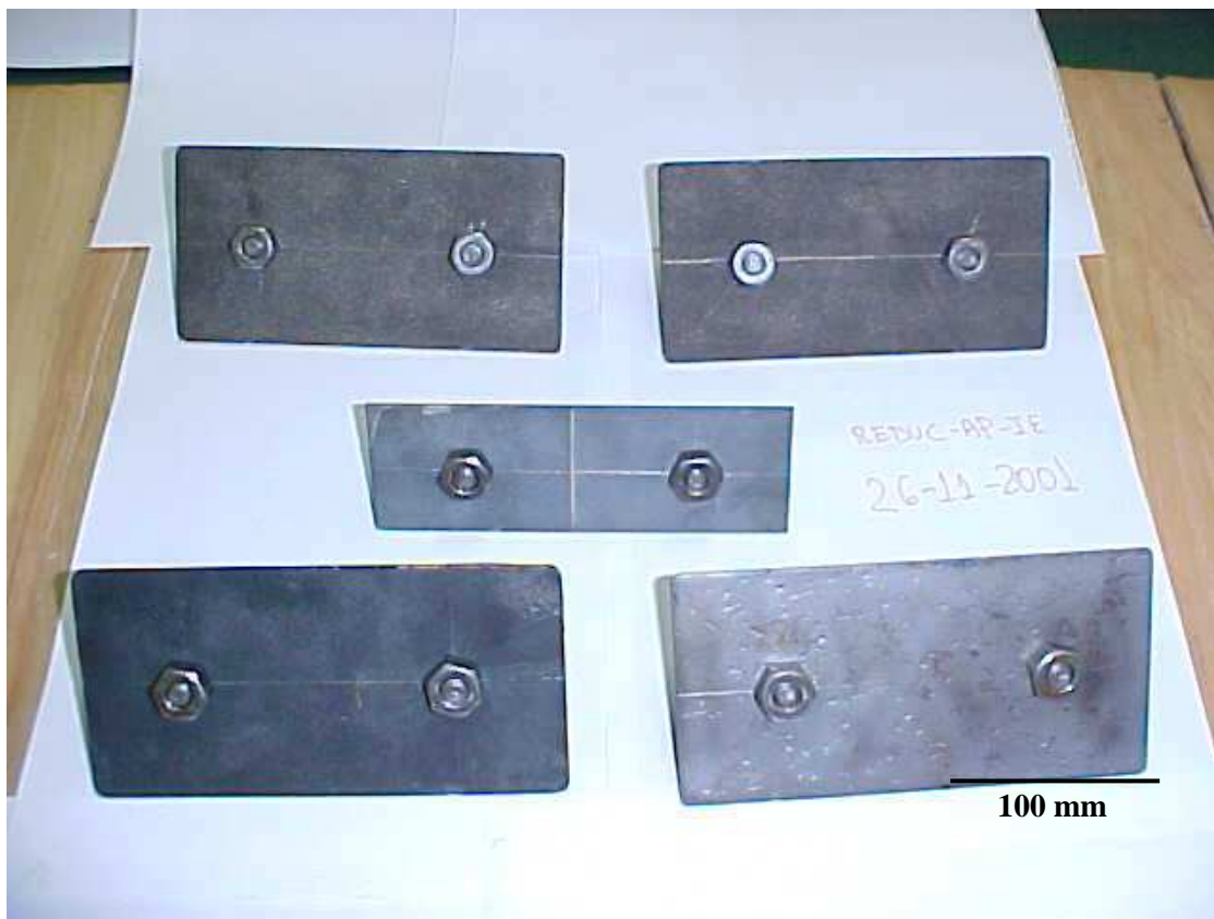
Figura 4.37- Corpos-de-prova de aço ao carbono revestidos e sem revestimento de Nb 2 O 5 (SCHULTZ et al. , 2003).
