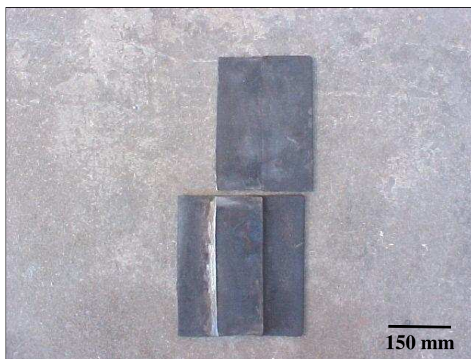
Figura 5.9- Corpos-de-prova revestidos com Nb 2 O 5 (SCHULTZ, 2004).
