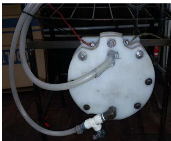
Figura 4.2 - Vista frontal do eletrolisador
