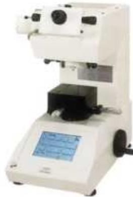
Figura 30 – Microdurômetro Shimadzu HMV-2
