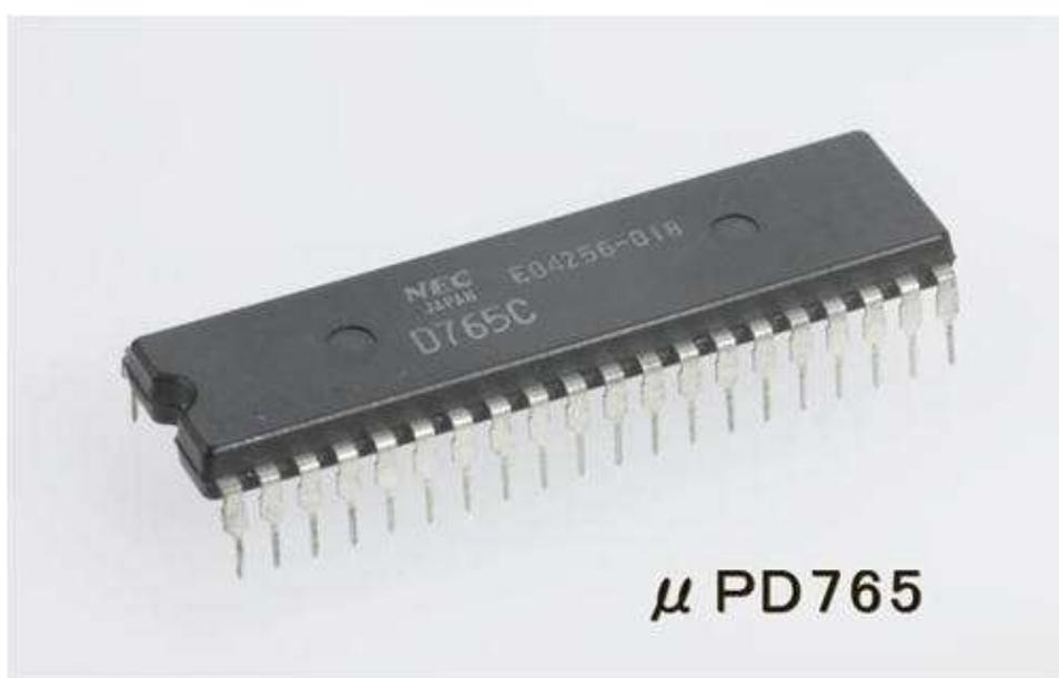
**Figura 18 – Componente dedicado para controladora de disquetes fabricada pela NEC na década de 80, modelo μPD765, com capacidade para controlar até quatro unidades de disquete de dupla densidade (MFM) [14].**
