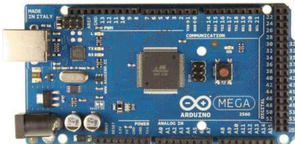
Figura 12 - Arduino Mega 2560, com microcontrolador ATMEGA 2560.
