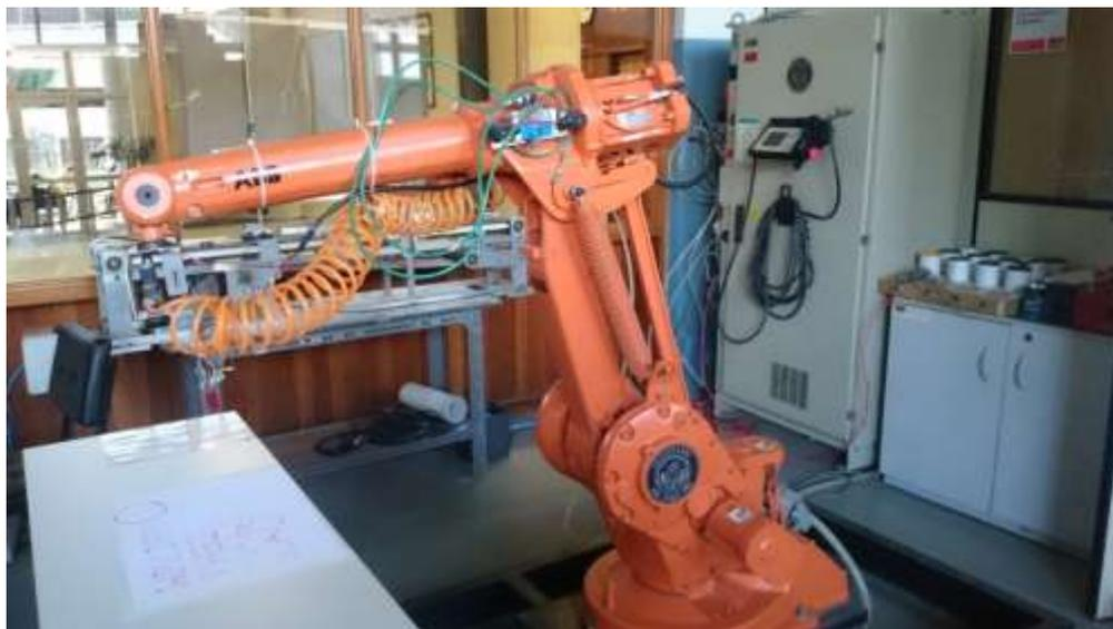
**Figura 2 - Robô ABB IRB-1400 instalado no laboratório de robótica da UFRGS.**
