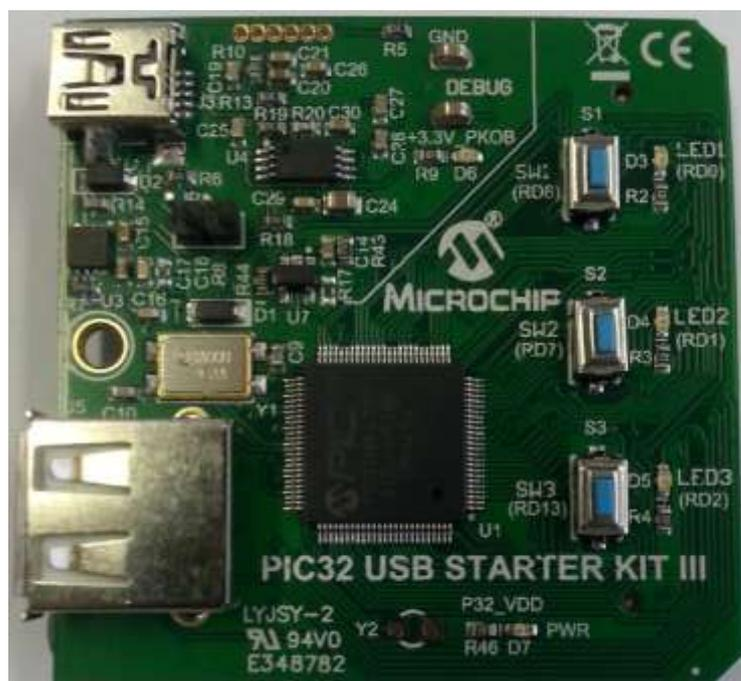
Figura 15 - Placa de desenvolvimento escolhida para o trabalho, modelo DM320003-3 [18]. Microcontrolador PIC32MX470F512L.
