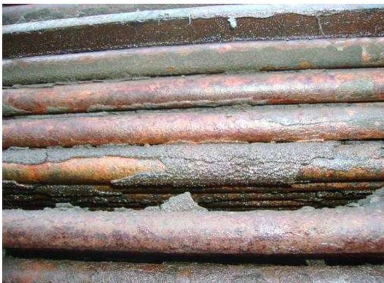
Figura 2.9 Depósito proveniente do fluido do processo sobre os tubos do feixe de um permutador de calor (LOTH, 2009)
