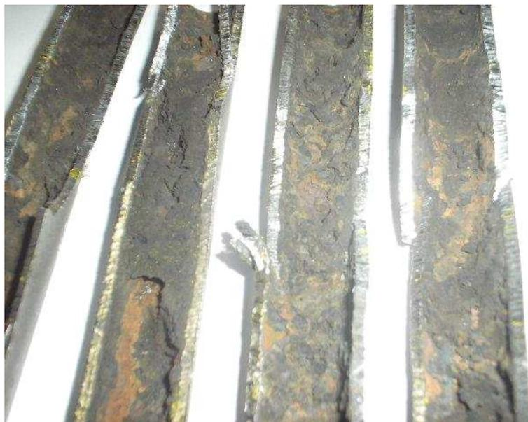
Figura 2.5 Incrustação no interior de tubos de permutador (LOTH, 2009)
