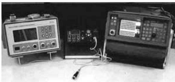
Figura 2.17 Monitores utilizados na inspeção por correntes parasitas (NDT, 2009)
