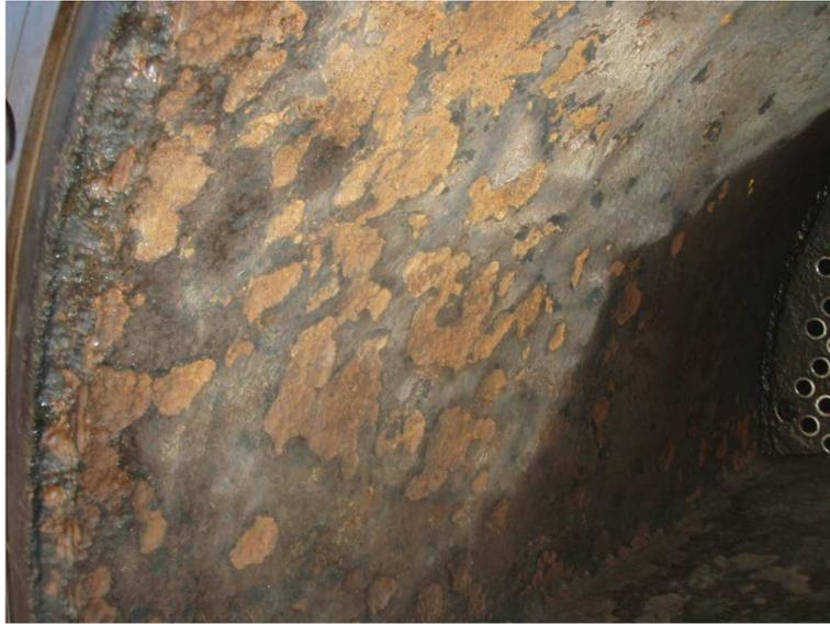
Figura 2.6 Fotografia do casco de um permutador de calor com corrosão alveolar generalizada (LOTH, 2009)
