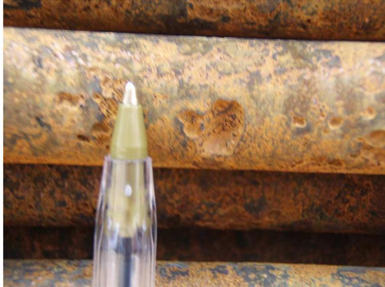
Figura 2.8 Corrosão por pite em tubo de permutador de calor (LOTH, 2009)
