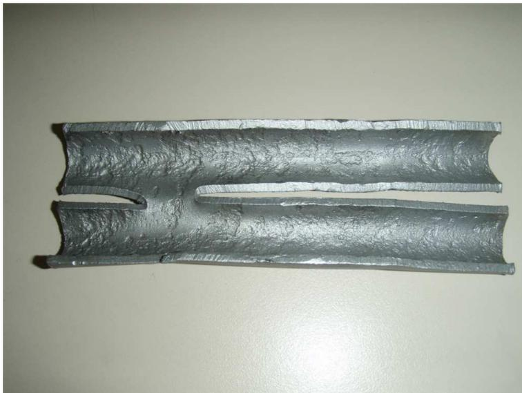
Figura 2.7 Fotografia do tubo da Figura 2.5 após limpeza. Superfície deteriorada por corrosão sob depósito (incrustação) (LOTH, 2009)
