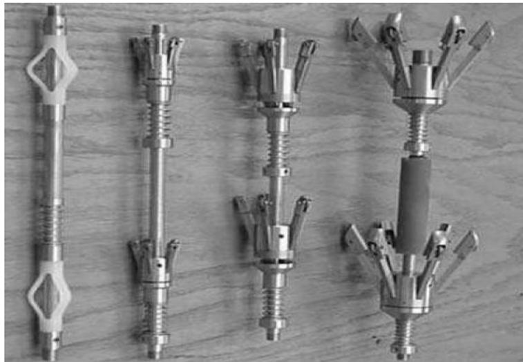
Figura 2.10 Cabeçotes utilizados na técnica IRIS, com diferentes centralizadores para diferentes diâmetros de tubo (BIRCHALL, 2007).
