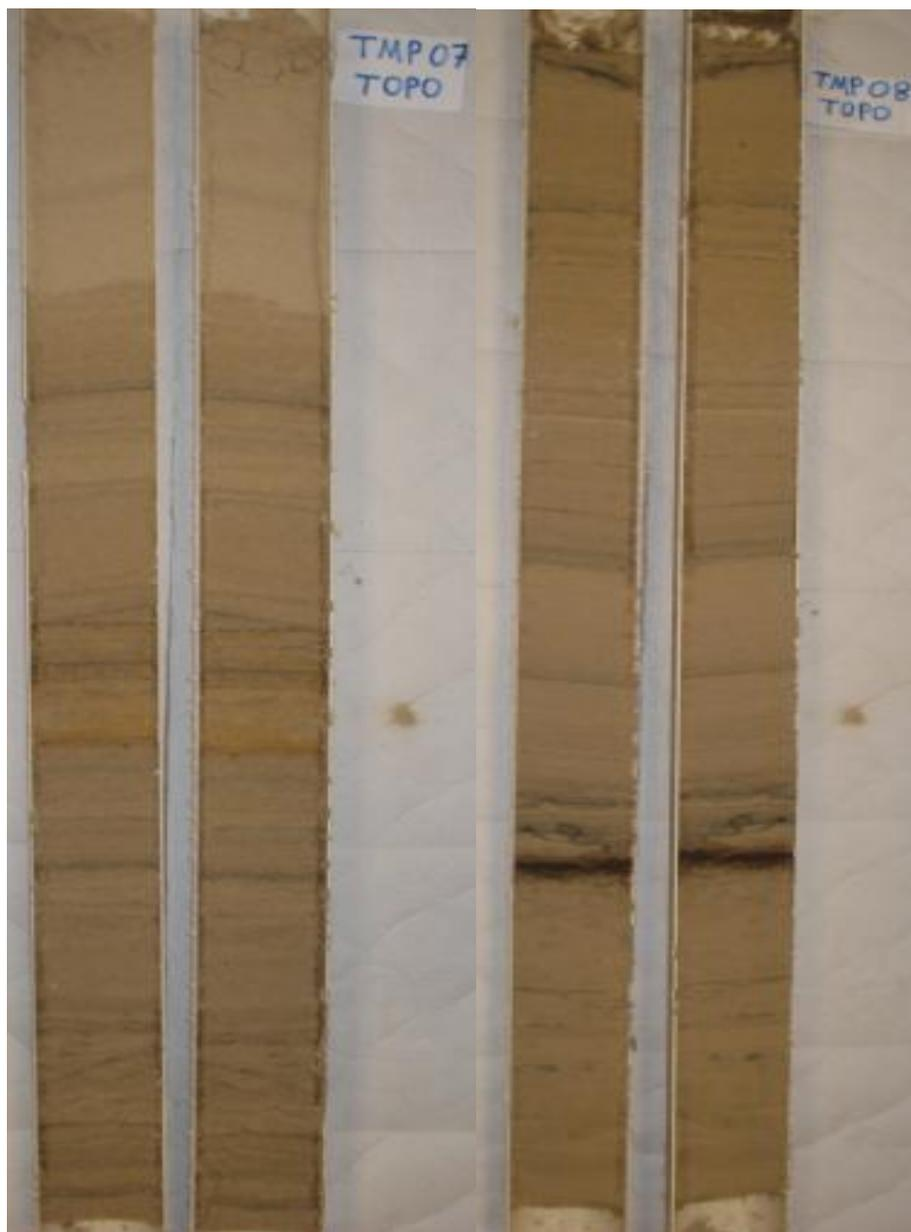
Figura 11: Testemunhos TMP07 e TMP08 mostram os níveis de concentração de minerais pesados. Diâmetro do cano de PVC: 7,5 cm
