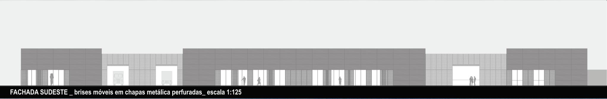
FACHADA SUDESTE \_ brises móveis em chapas metálica perfuradas\_ escala 1:125
