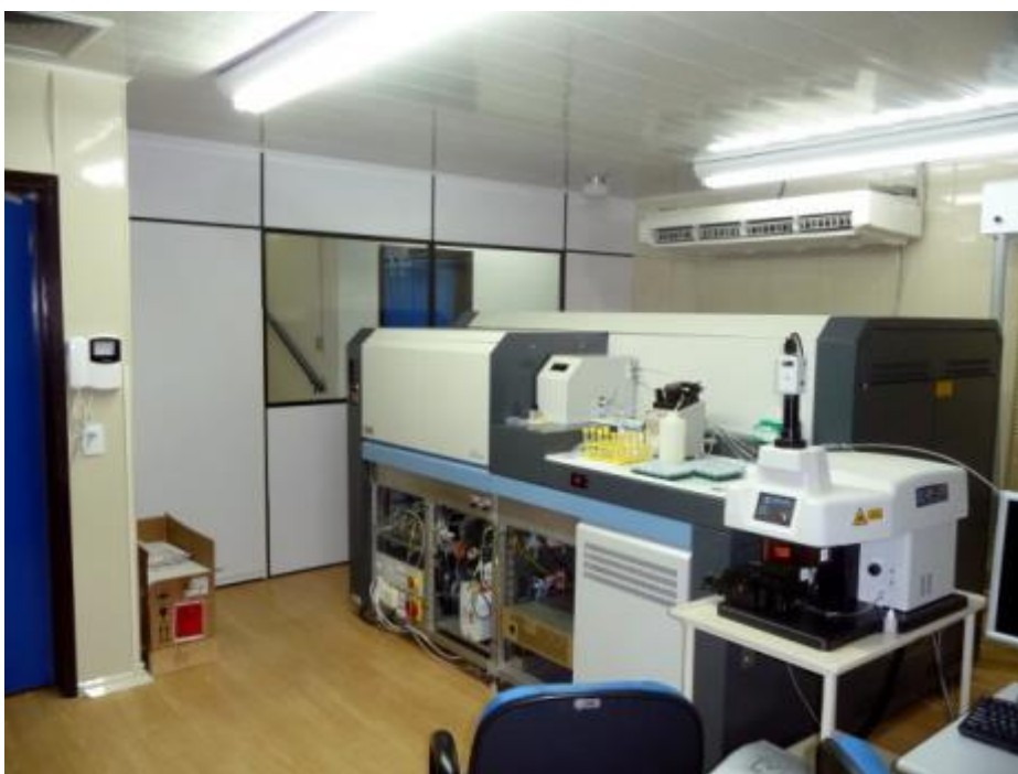
Figura 13. Espectrômetro de Massas da marca Thermo Scientific® Neptune Plus®, utilizado para obter as análises de geoquímica isotópica (Sm/Nd) do projeto.
