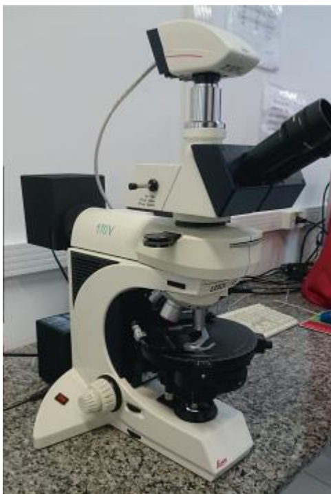
Figura 10. Imagem do microscópio da marca Leica DMLP utilizado para as descrições petrográficas das lâminas do projeto.
