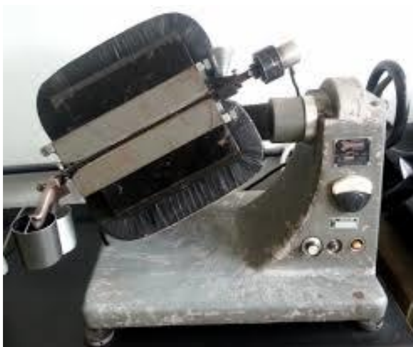
Figura 8. Imagem referente ao equipamento de separação magnética Frantz, utilizado para concentrar minerais com diferentes amperagens.
