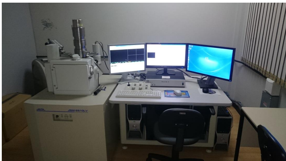
Figura 11. Imagem do MEV modelo JEOL® 6610-LV, utilizado para obter imagens de BSE e CL. Possui também EDS acoplada, para a obtenção de análises composicionais.
