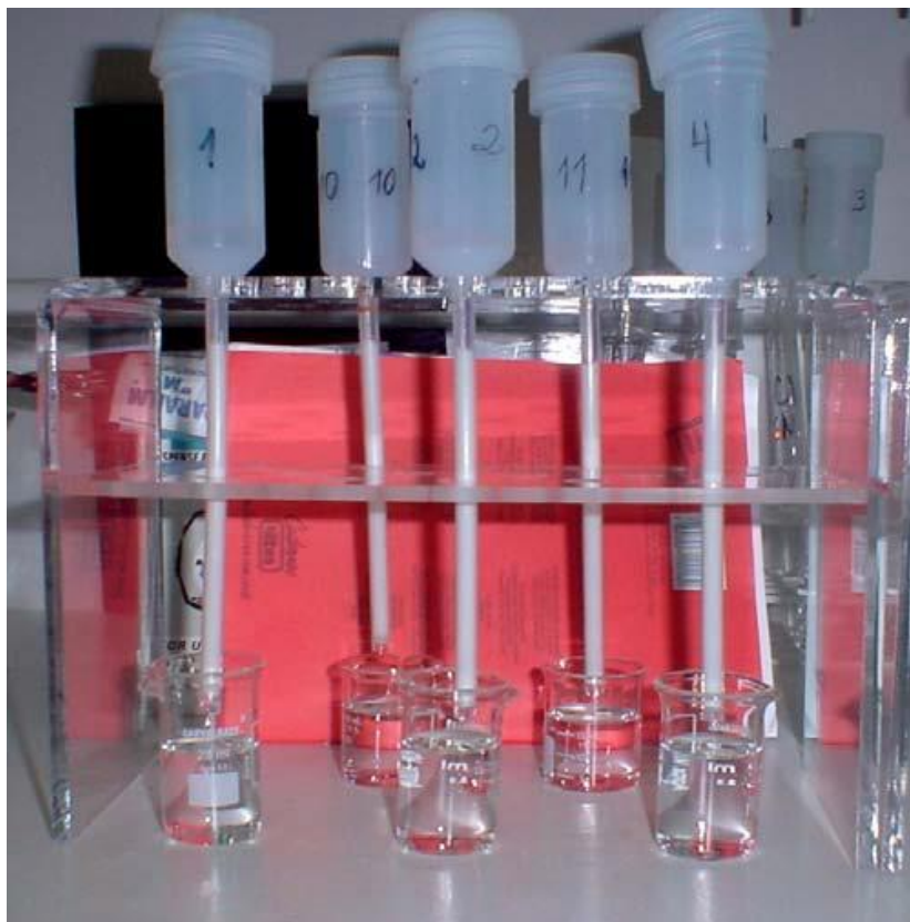
Figura 12. Colunas com resina aniônica, utilizadas para a concentração dos ETR's para análise de geoquímica isotópica.
