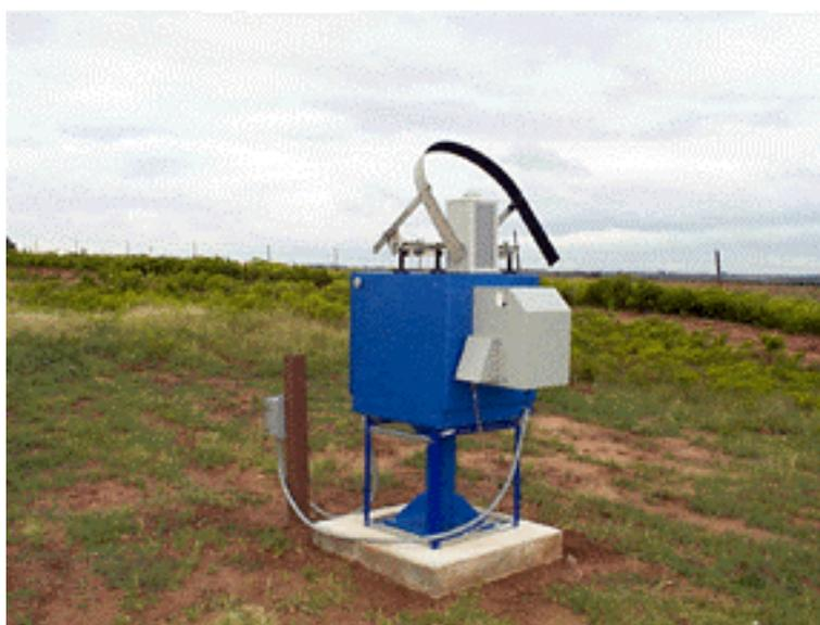
Figura 1.2 – Fotografia do VTLC, equipamento que emprega uma câmera *CCD* para fornecer imagens e gravar vídeos, que permitem estudar as condições de nebulosidade.
