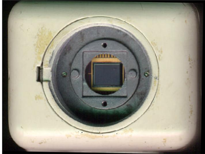
Figura 4.7 – Fotografia do sensor da câmera.
