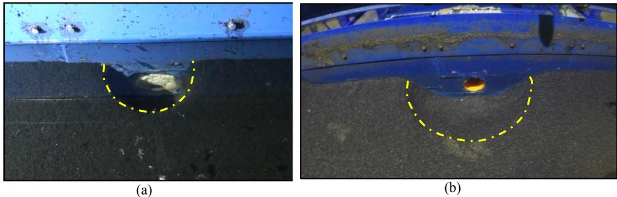
**Figura 4.** -Foto das conformações de fundo geradas pelos descarregadores de fundo nos DN’s de 33mm (a) e 100mm(b), respectivamente. Fonte: LOH/UFRGS (2018).
