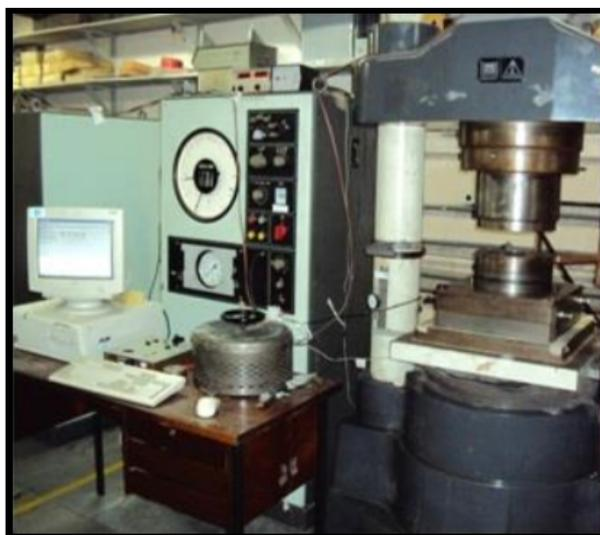
Figura 3.3: Prensa hidráulica de 400 Tonf.
