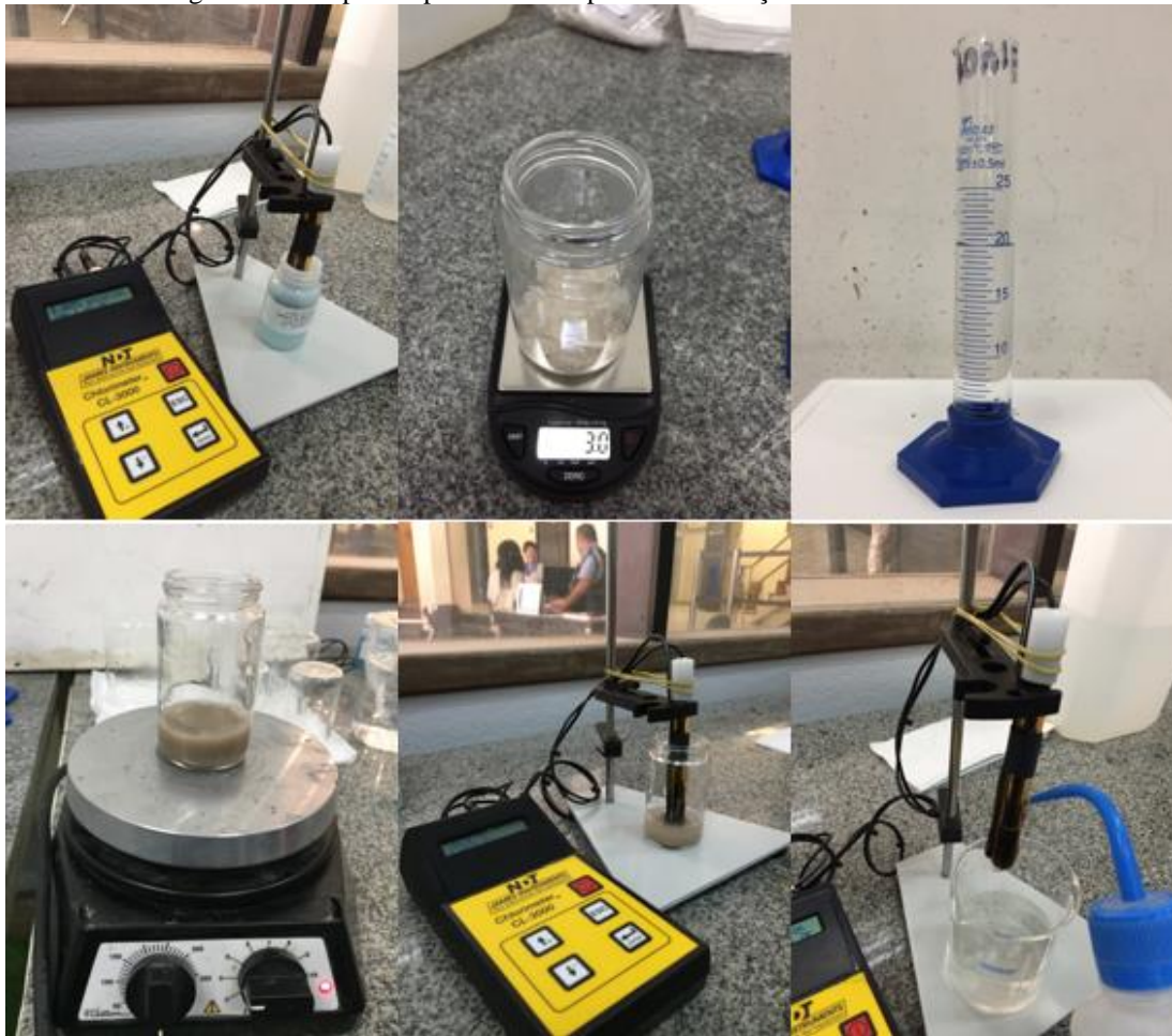
Figura 26 – Etapas do procedimento para determinação do teor de cloretos
