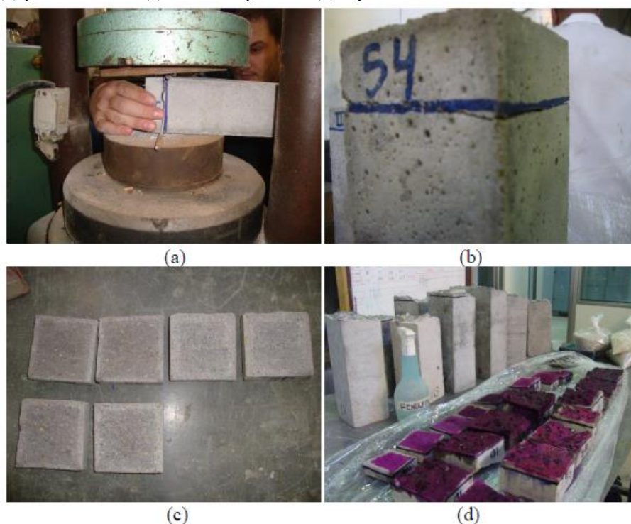
Figura 17 – Procedimento padrão para determinação da profundidade de carbonatação (a) quebra do prisma na prensa; (b) prisma fatiado; (c) fatias dos prismas; (d) aspersão de fenolftaleína nas fatias dos prismas
