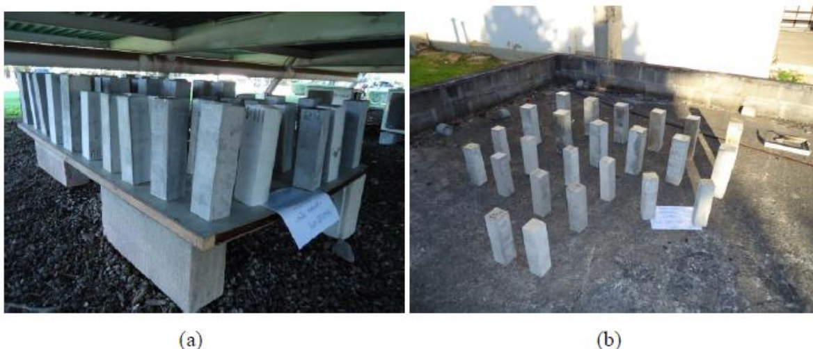
Figura 16 – Prismas de concreto e argamassa expostos em Vitória (a) em local externo protegido da chuva; (b) em local externo desprotegido da chuva
