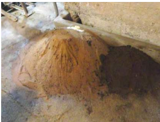
Figura 26 – Material que saiu de dentro do dreno 85P em ago./2010. (Fonte: CEEE-GT, 2016)
