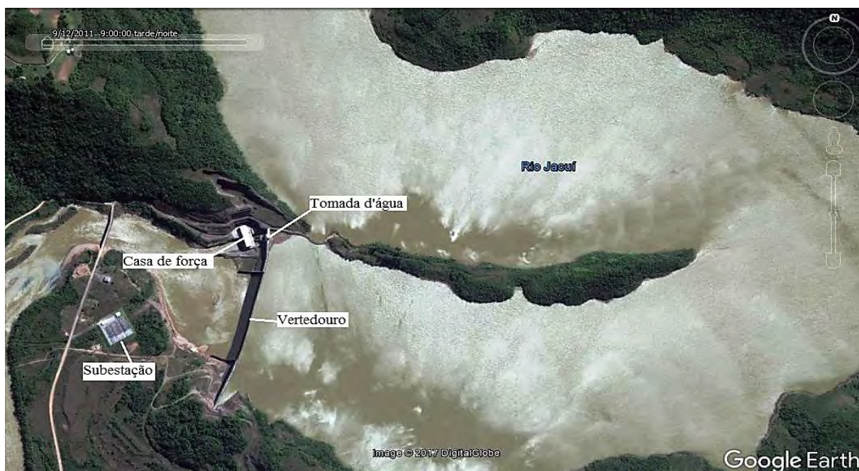
Figura 13 – Arranjo geral da UHE Dona Francisca (Fonte: GOOGLE INCORPORATION 18 , 2018)
