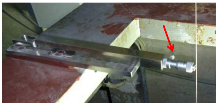
Figura 32 – Coordenômetro micrométrico da UHE Dona Francisca
