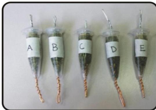
Foi feito um monitoramento por um período próximo a 80 dias, medindo-se a tensão e observando-se a degradação do material.
