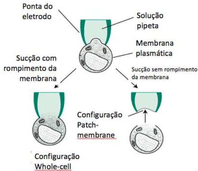
**Figura 10:** Diagrama da configuração de registro de Patch Clamp e Whole Cell. Fonte: “Plant Physiology and Development, Sixth Edition”.
