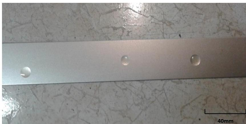
Figura 43 – Aplicação do lubrificante sobre as chapas
