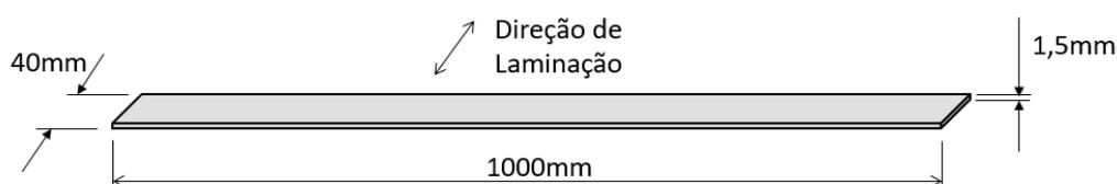
Figura 41 – Dimensões dos corpos de provas
