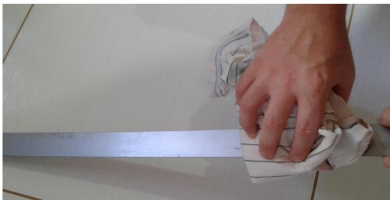
Figura 42 – Operação de limpeza das chapas antes de cada ensaio
