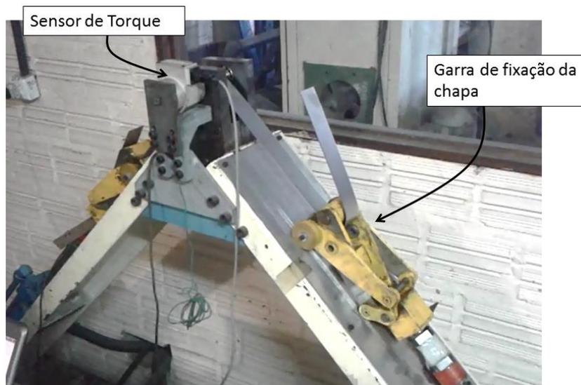
Figura 34 - Equipamento de dobramento sob tensão
