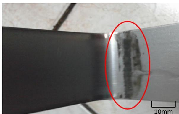
Figura 49 – Acúmulo de resíduos provenientes do acabamento superficial da chapa no material B
