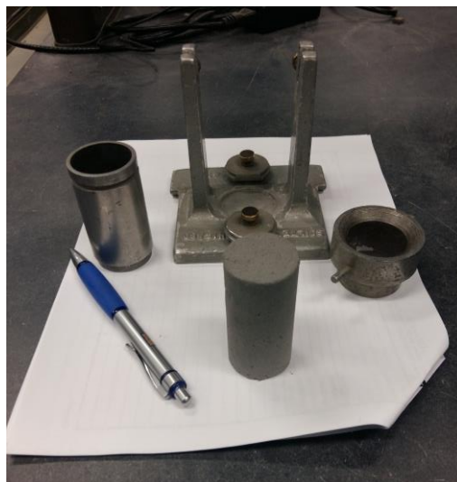
Figura 14 - Molde utilizado para os ensaios de Lixiviação em Coluna.
