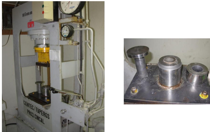
Figura 13– Prensa e molde adaptado para confecção dos corpos-de-prova para RCS e durabilidade.
