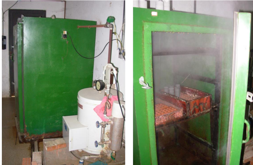
Figura 15– Câmara de vapor utilizada para cura dos corpos-de-prova em temperaturas de 40°C.
