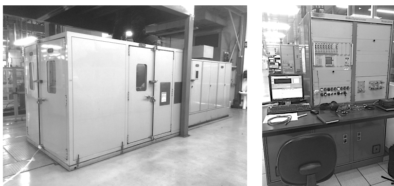
Figura 3.1 – Vista geral do dinamômetro e seu painel de controle (Fras-le).
