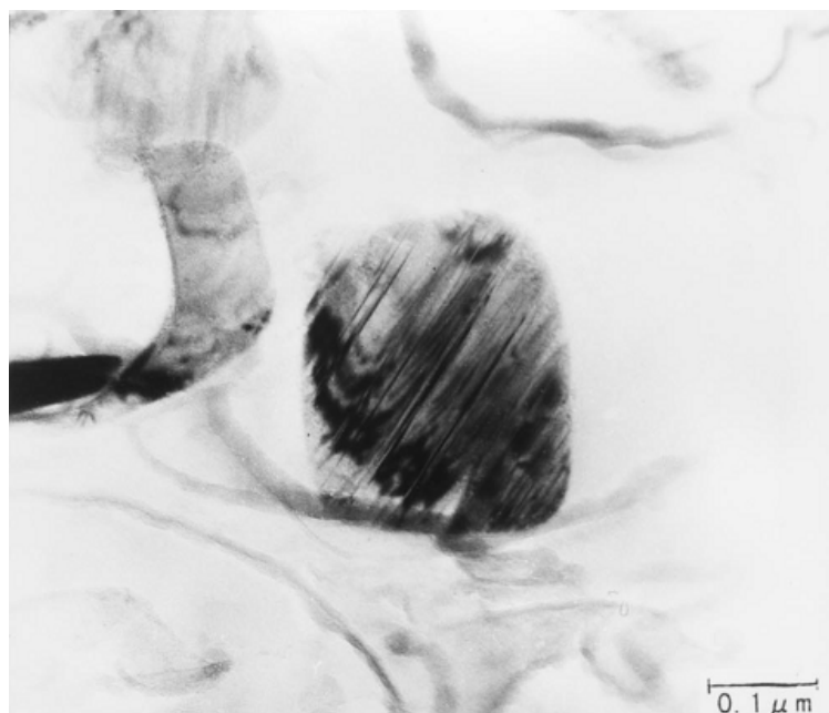
Figura 2.9 Micrografia obtida por MET de precipitados \gamma' extraídos da liga 718 envelhecida a 740°C por 72 ks e deformada a frio até a redução de 15%. Franjas internas que evidenciam falhas de empilhamento (KUSABIRAKI 1999).
