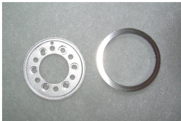
Figura 43: Duas peças de alumínio obtidas da desmontagem de um disco rígido de computador.
