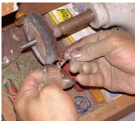
Figura 58: Polimento final do broche em politriz elétrica.
