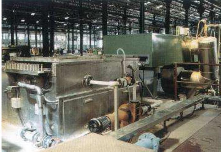
**Figura 17 - Sistema de fluxagem (com cloreto duplo de zinco e amônio)**
