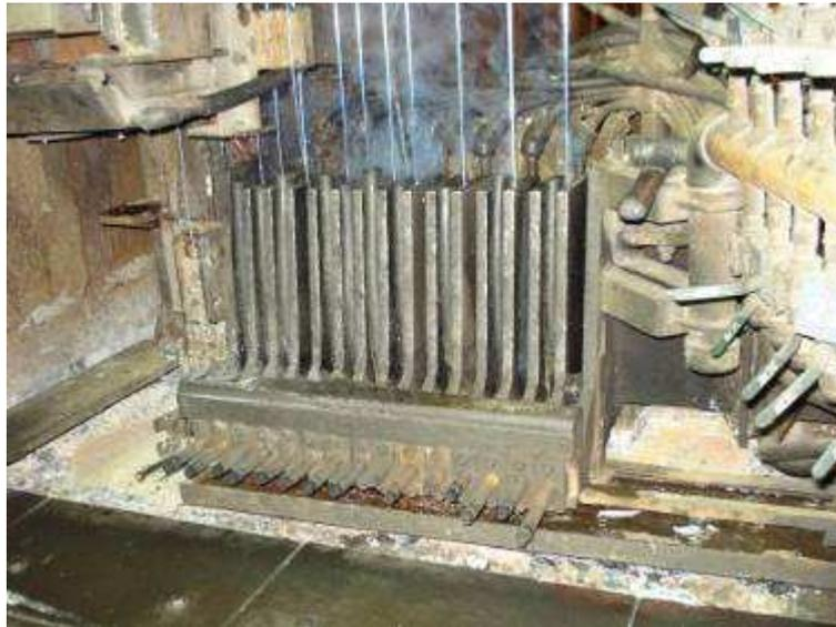
**Figura 27 - Sistema prensa gaxeta – arames de camada leve**
