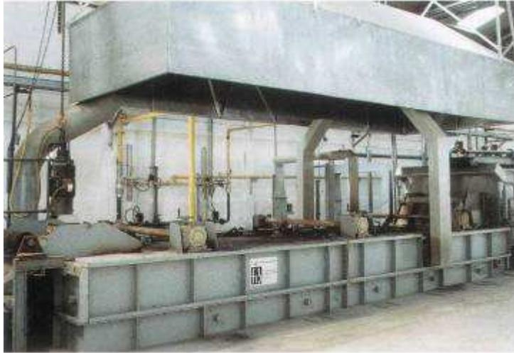
**Figura 15 - Forno de recozimento (por imersão em chumbo)**
