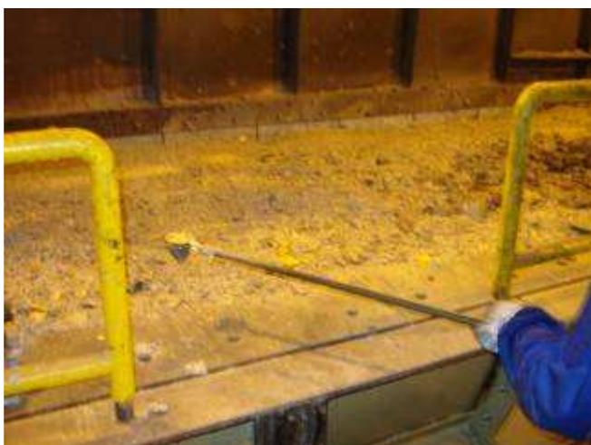
**Figura 34 - Retirada de cadinho com amostra do banho de zinco**
