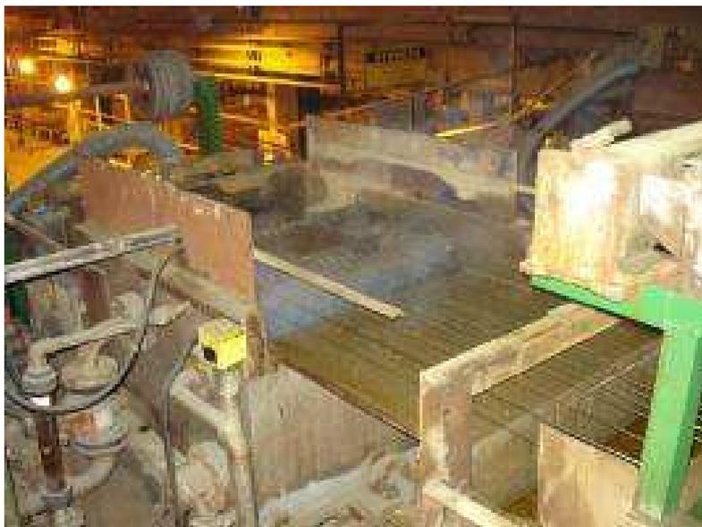
**Figura 20 - Tanques de passivação**
