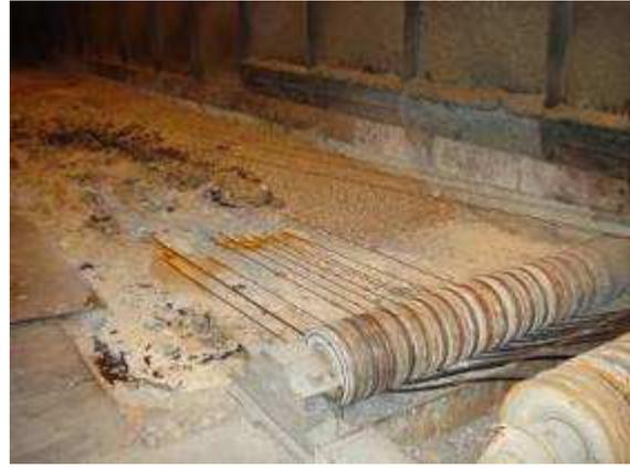
**Figura 23 – Roldanas de posicionamento dos arames para imersão em cuba completa ou em meia cuba**
