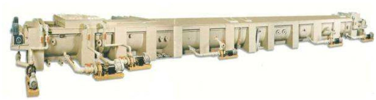
**Figura 16 - Sistema de decapagem química (com solução de ácido clorídrico)**
