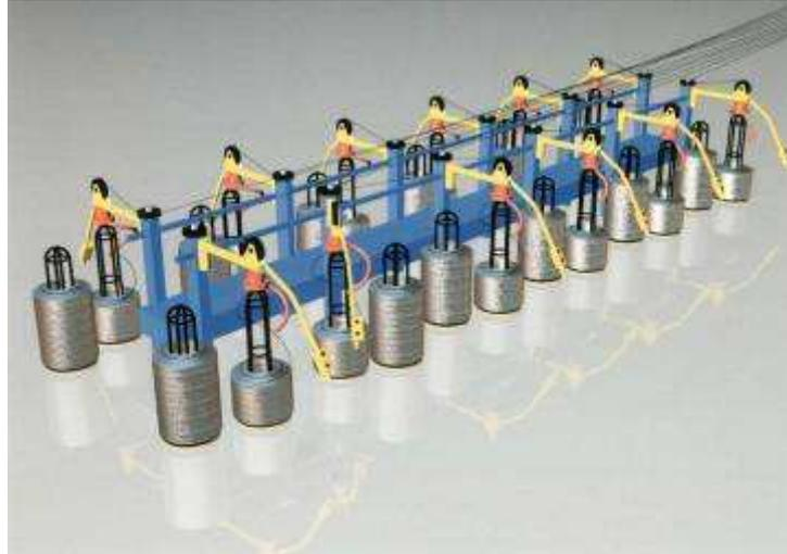
**Figura 14 - Sistema de desbobinamento dos arames**
