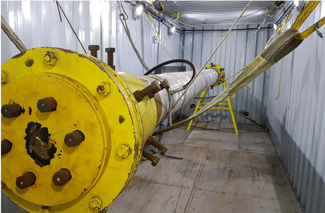
Figura 43 - Amostra 2 posicionada na bancada de fadiga por ressonância.
