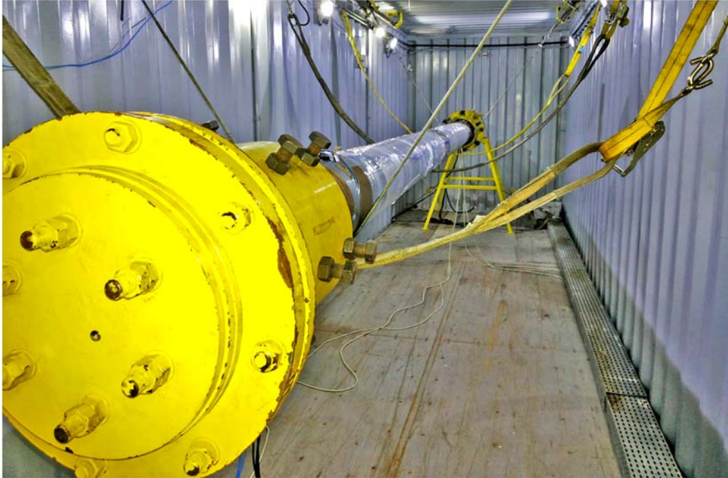
Figura 42 - Amostra 1 posicionada na bancada de fadiga por ressonância.
