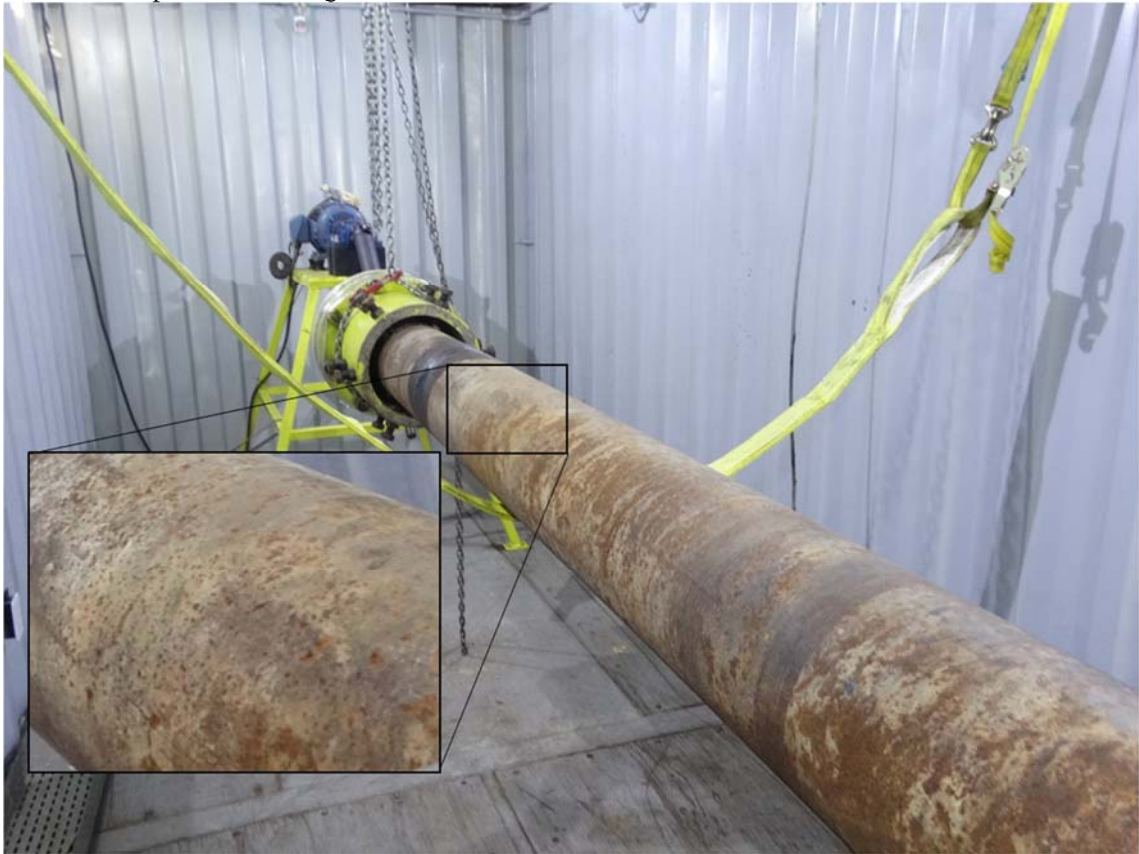
Figura 38 - Exemplo de corrosão generalizada na amostra 1.
