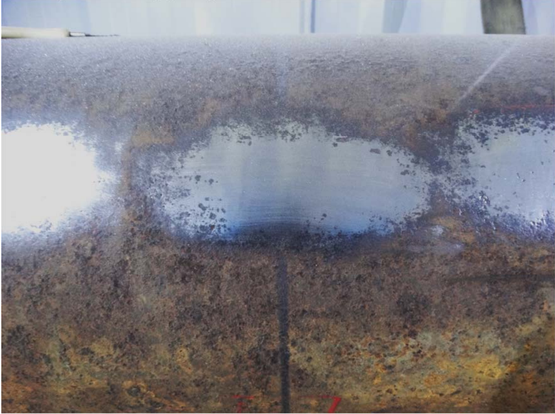
Figura 39 - Região da amostra 2 preparada para instalação dos sensores de deformação e aceleração.
