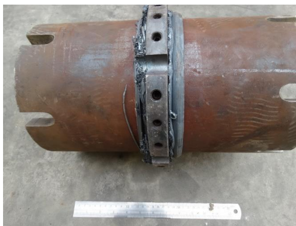
Figura 4-1 – Tubo soldado na MASF 1500.
