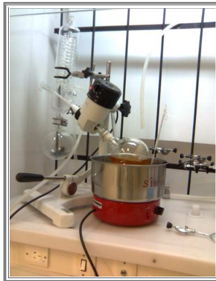
Figura 9 – Utilização do sistema de rota-evaporação à vácuo para retirada do excedente de solvente utilizado: o metanol
