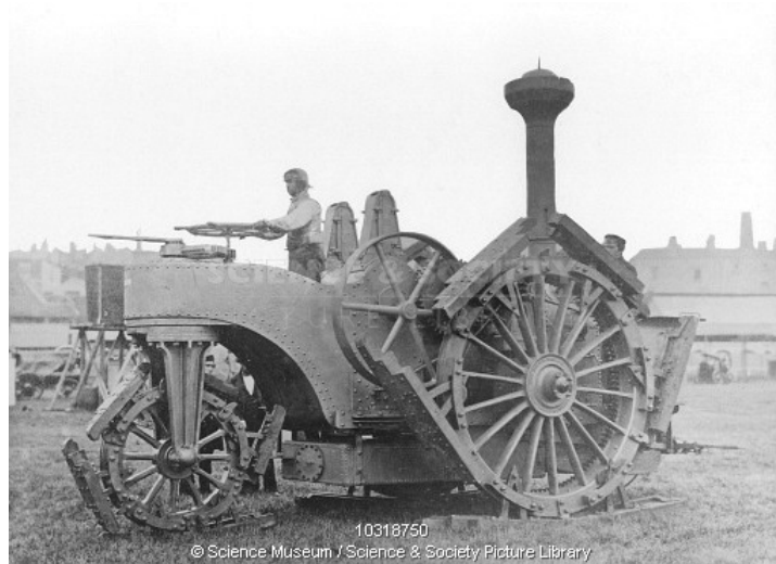
Figura 3: Trator Boydell de “rodas com pés”. Meados do século XIX.
