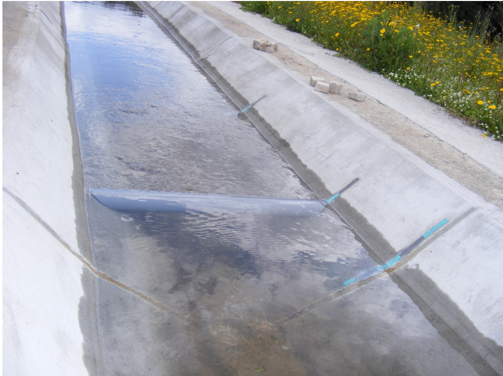
Figura 38 – Tubo e escalas de medição colocados no canal trapezoidal inferior do NUHCC
