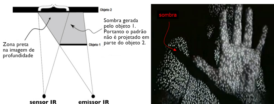
Figura 15 – Efeito das sombras no sensor Kinect
