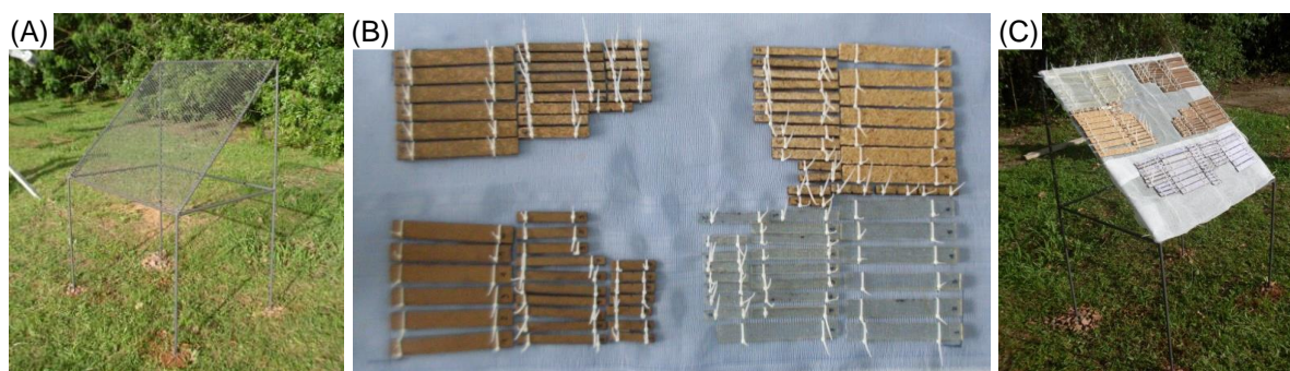
Figura 43: Ensaio de intemperismo natural: A) Suporte para ensaio de intemperismo natural, B) Fixação dos corpos de prova na tela e C) Suporte com os corpos de prova.
