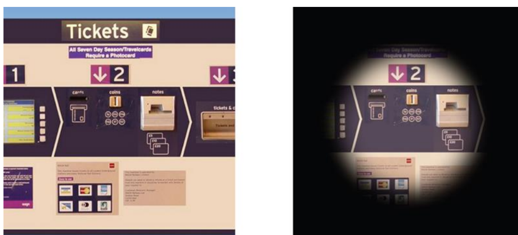
Figura 10: interface de uma máquina de venda de ingressos redesenhada para favorecer o destaque da informação principal no acesso por quem possui a visão periférica comprometida.
