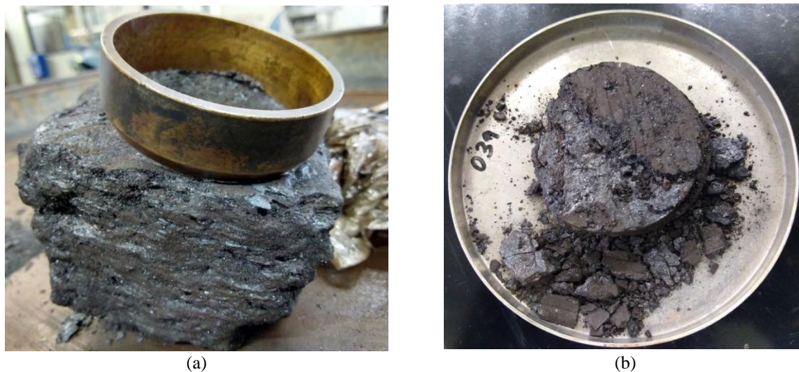
Figura 5.17 – Bandamento na orientação horizontal: (a) posição da orientação horizontal do bandamento; (b) corpo de prova ensaiado na umidade natural (H N-150) (registrado pela autora)
