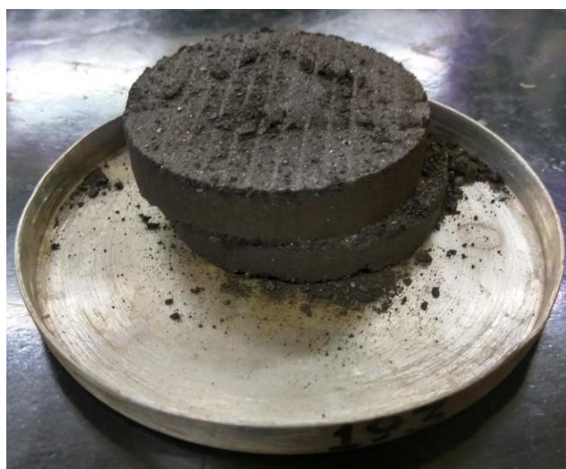
Figura 5.2 – Corpo de prova remoldado ensaiado na umidade natural (R N-100) (registrado pela autora)
