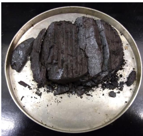
Figura 5.12 – Corpo de prova ensaiado com o bandamento na orientação vertical em condição natural de umidade (V N-150) (registrado pela autora)
