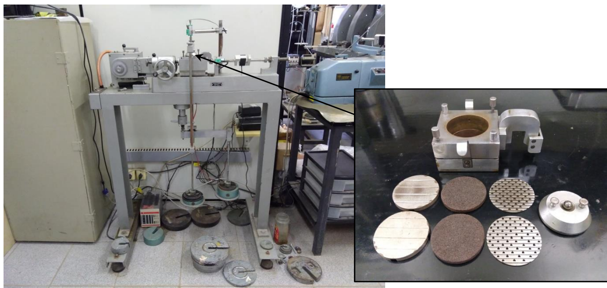
Figura 4.5 – Prensa utilizada para a execução dos ensaios de cisalhamento direto com detalhe da caixa de cisalhamento desmontada (registrado pela autora)
