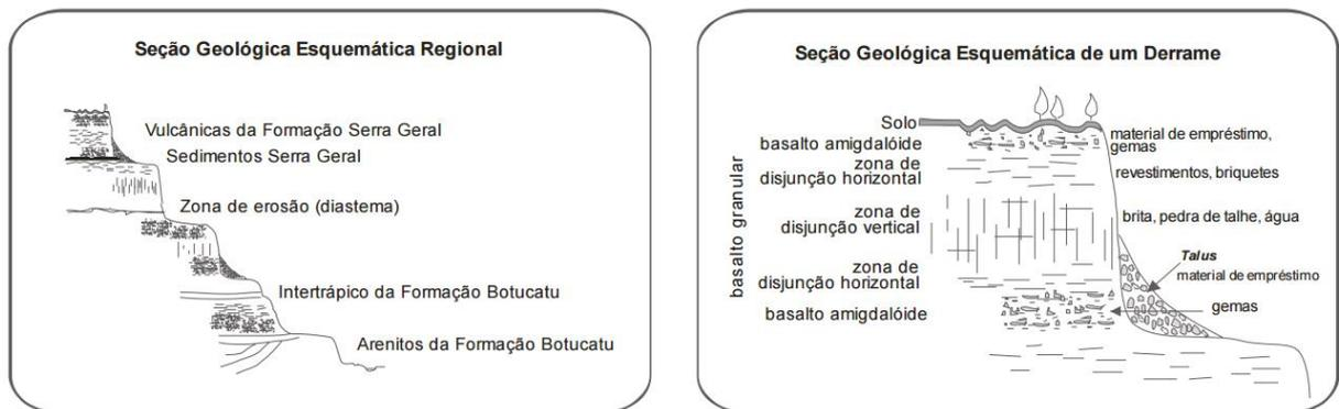
**Figura 2 - Representação esquemática da estruturação dos derrames da Bacia do Paraná**
