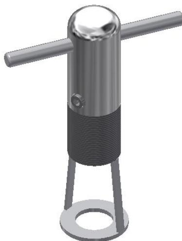
Figura 5.9 – Conjunto final do parafuso de potência.
