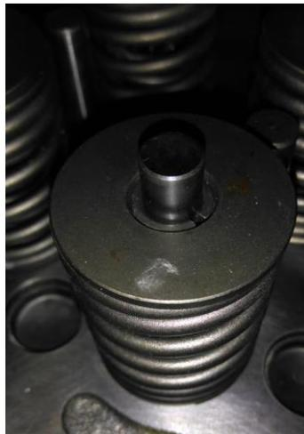
Figura 4.1 – Estrutura do conjunto de válvulas de admissão e escape, com enfoque no prato de mola, chavetas e molas.
