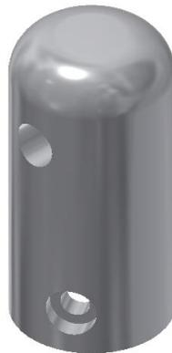
Figura 5.6 – Elemento para auxílio de torção com enfoque nas cavidades de encaixe da haste de torção e de fixação da peça removível.
