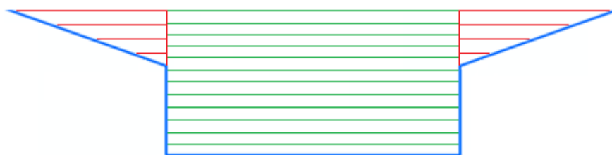
Figura 6. Porção ativa da calha onde é calculado o escoamento (verde) e inativa onde a velocidade é considerada zero (vermelho).
