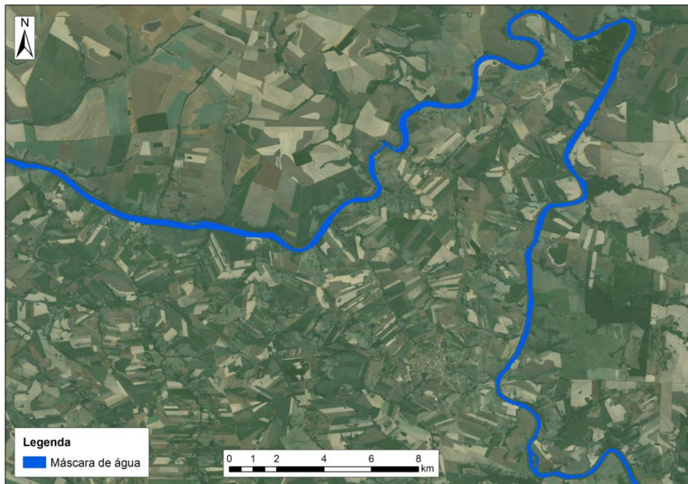
Figura 14. Máscara de água extraída com uso do classificador Iso Cluster.
