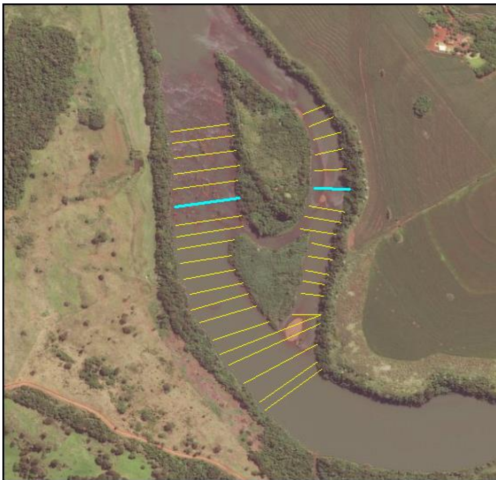
Figura 19. Medições transversais realizadas manualmente sobre um trecho com ilha.
