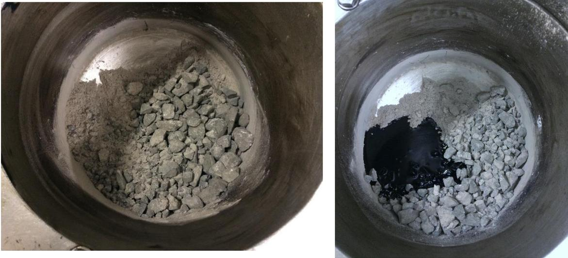
Figura 32 - Homogeneização dos materiais para mistura
