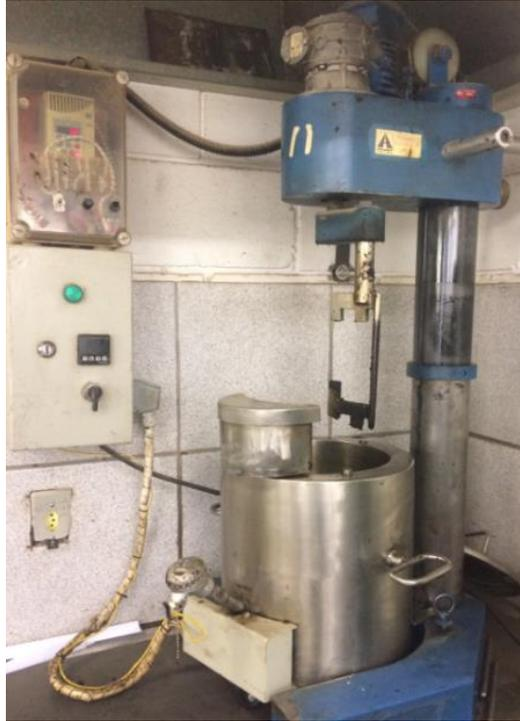
Figura 31 - Cuba com sistema de aquecimento e pá automática
