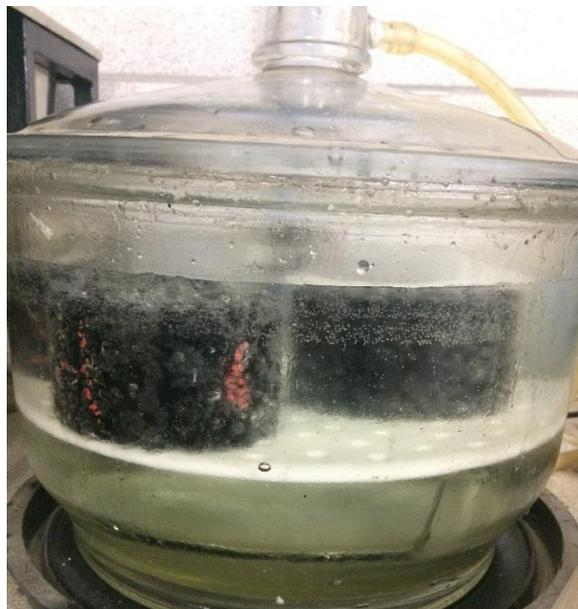
Figura 36 - Corpos de prova submetidos à aplicação de vácuo
