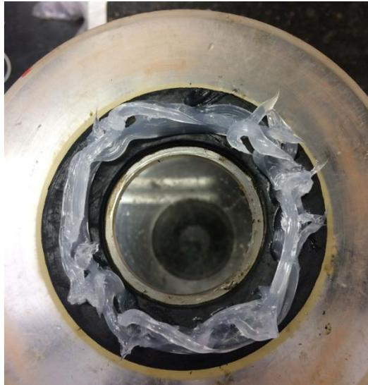
Figura 45 - Aplicação de silicone para vedação no anel de borracha rígida do permeâmetro
