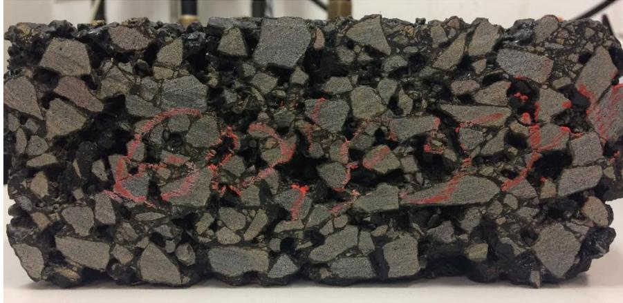
Figura 47 - Corpo de Prova serrado
