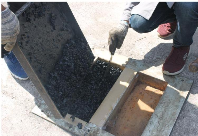
Figura 41 - Processo de preenchimento do molde com a mistura asfáltica
