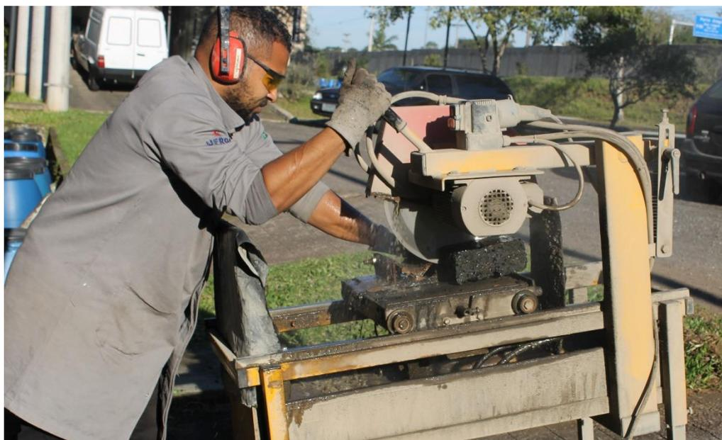
Figura 46 - Serra utilizada para o corte das placas de CPA
