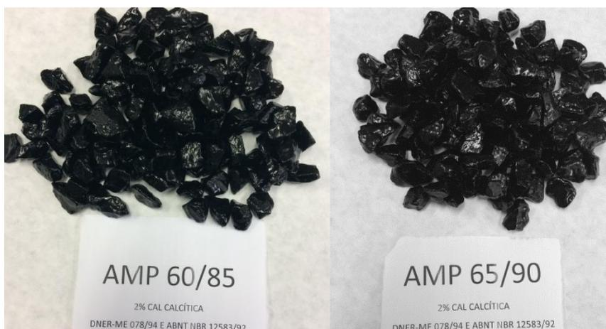
Figura 26 - Ensaio de adesividade dos ligantes asfálticos
