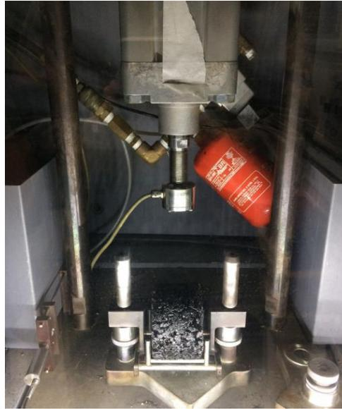
Figura 50 - Corpo de prova posicionado na câmara com temperatura controlada para o ensaio de módulo de resiliência
