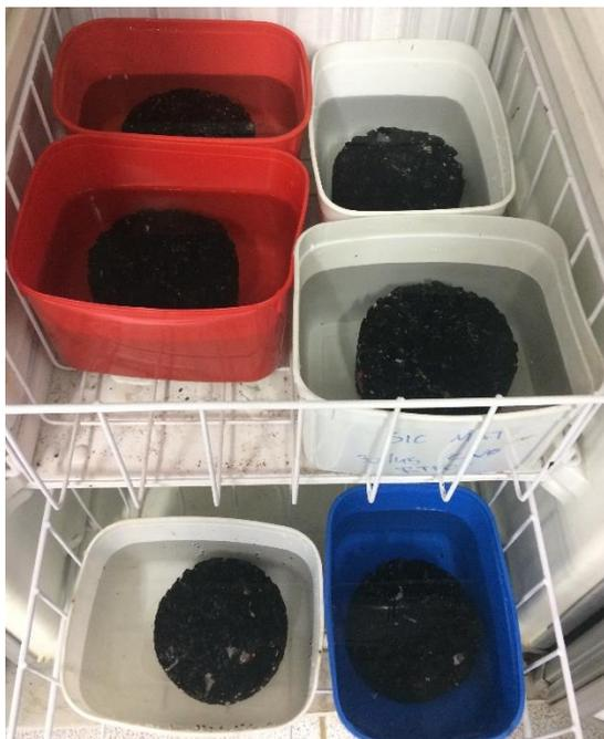
Figura 37 - Corpos de prova submersos para iniciar o ciclo de congelamento
