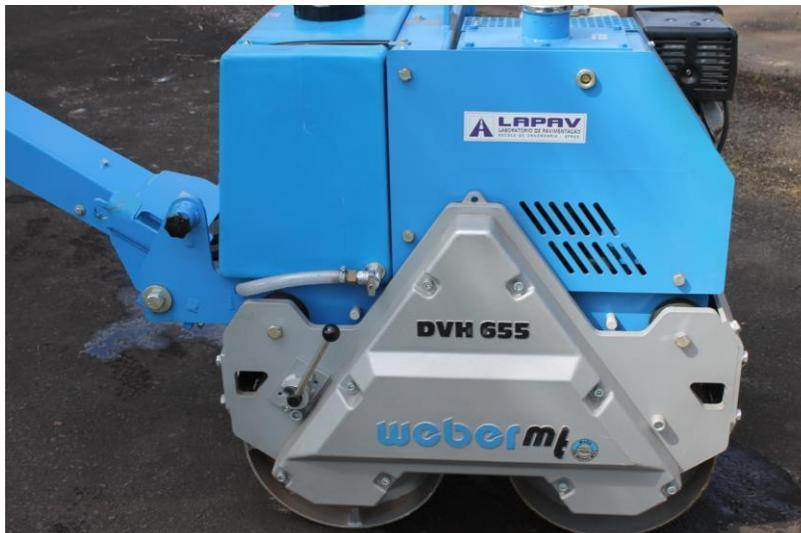
Figura 42 - Rolo compactador utilizado na compactação das placas
