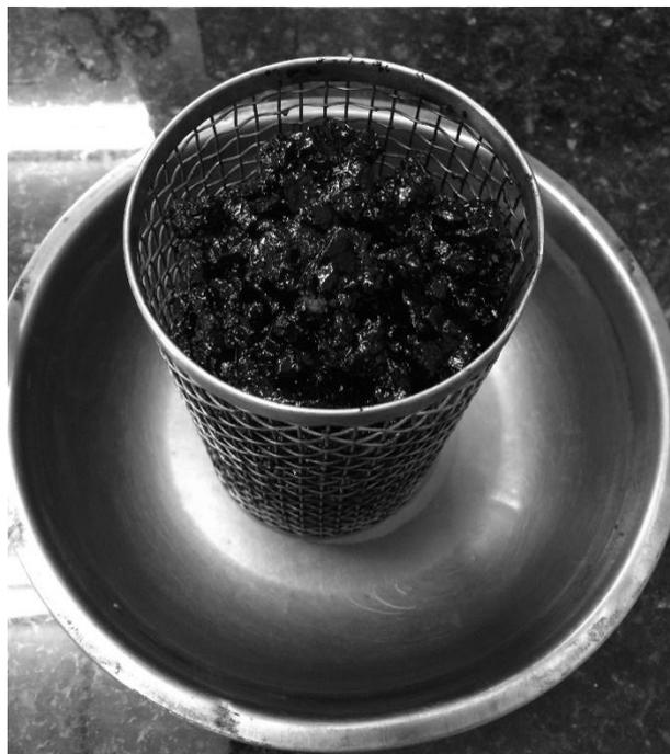
Figura 33 - Amostra acondicionada na cesta de abertura 6,3 mm
