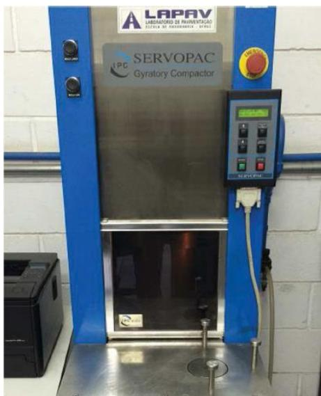
Figura 29 - Compactador giratório Superpave
