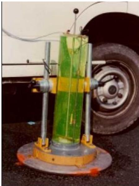
Figura 16 - Permeâmetro de carga variável sobre o revestimento (fonte: Momm, 2002 Apud Oliveira, 2003)
