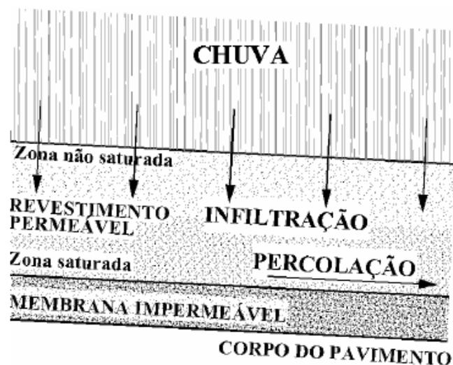
Figura 10 - Infiltração e percolação em CPA (fonte: GNCSC, 1996 Apud Dumke, 2005)
