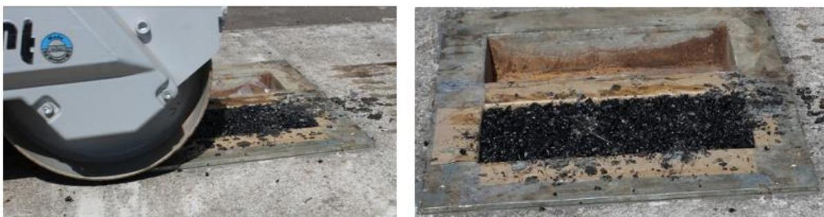
Figura 43 - Procedimento de compactação das placas
