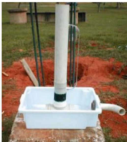
Figura 17 - Permeâmetro de carga variável para CPs Marshall (fonte: Oliveira, 2003)
