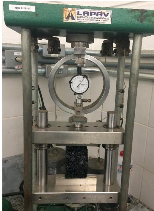
Figura 49 - Ensaio de resistência à tração
