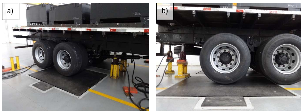
Figura 48 – Levantamento do veículo para calibração dos extensômetros
