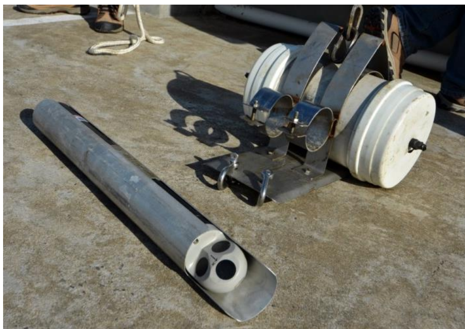
Figura 4. Perfilador acústico de correntes por Doppler (Aquadopp) com o lastro (branco) utilizado para o lançamento a partir da Plataforma de Pesca.
