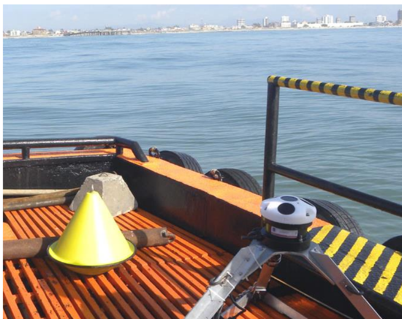
Figura 3. Fotografia do perfilador acústico de ondas e correntes (AWAC) na popa do barco Sea Green.
