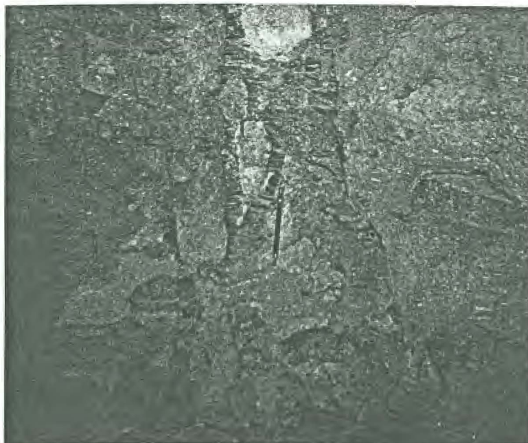
Figura 7.7c - Fotografia de detalhe do dique constituído por lentes de arenito, de material vítreo e de basalto portador alterado.
