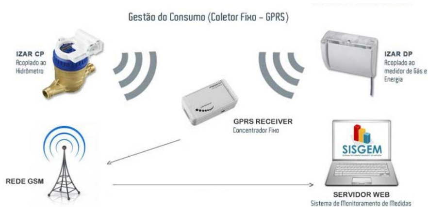
Figura 9 - Esquema de sistema via GPRS (Fonte: TECMETRA, 2018)
