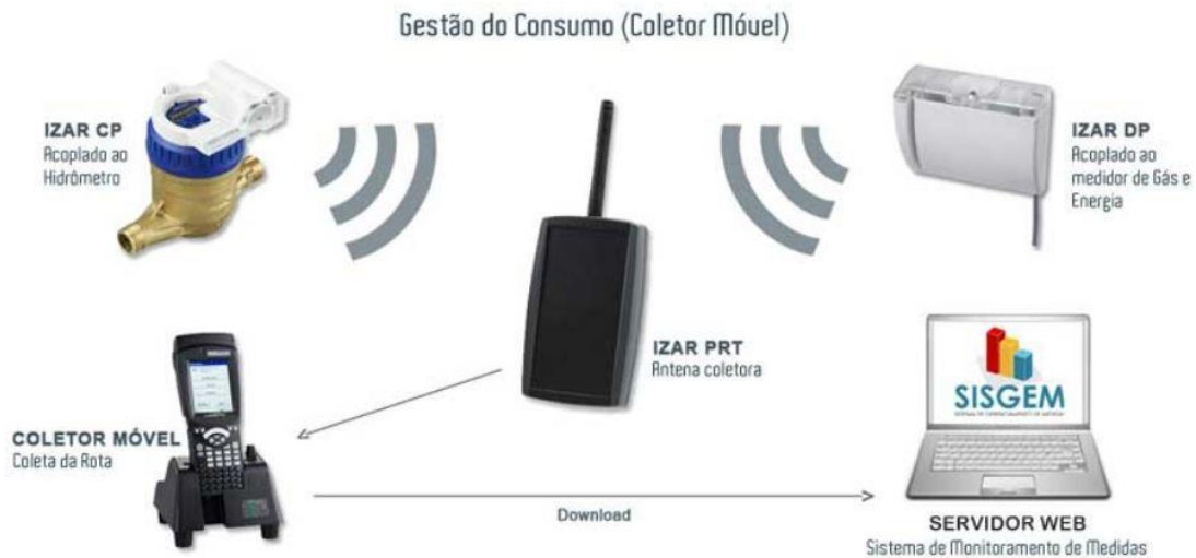
Figura 11 - Esquema de sistema via coletor móvel (Fonte: TECMETRA)
