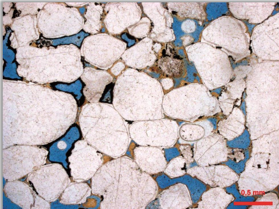
Foto 15 - Grão de feldspato parcialmente dissolvido, evidência que corrobora o aumento da porosidade primária. Os grãos de quartzo apresentam intercrescimento, com a ocorrência de cutícula de argila infiltrada.
