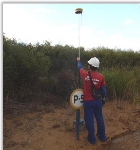
Foto 2 - Coleta da cota topográfica do nível da água na Sanga da Carvoeira.
