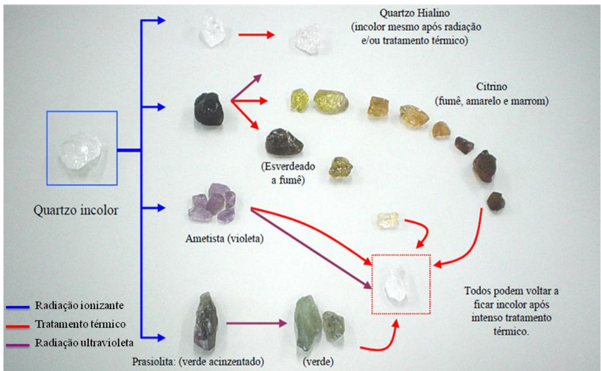
Figura 7. Ilustração da obtenção de cores a partir de quartzo incolor. As setas azuis representam a radiação ionizante; as setas vermelhas, tratamento térmico; e roxas indicam a radiação ultravioleta. Fonte: Modificado de Alkmim, 2012.
